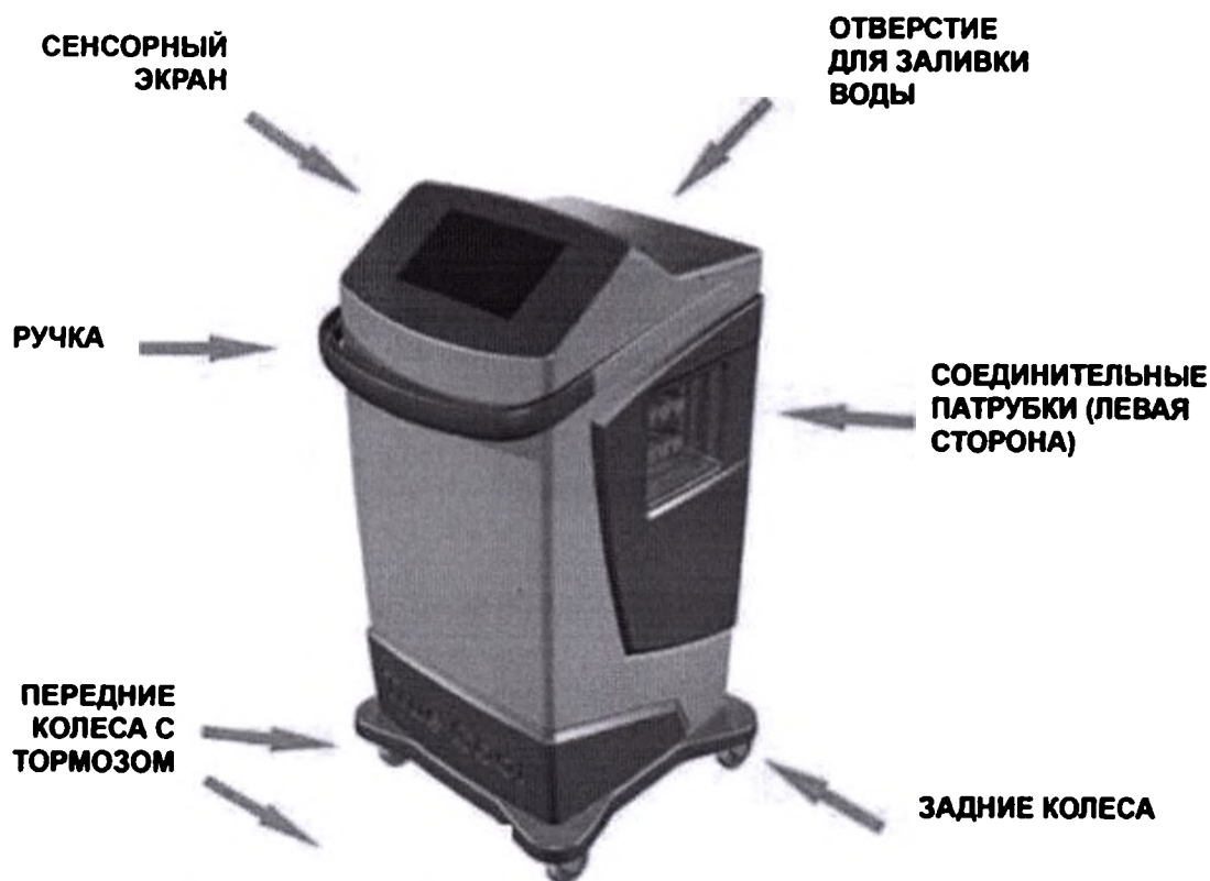
Рисунок 1 Описание блока управления.
