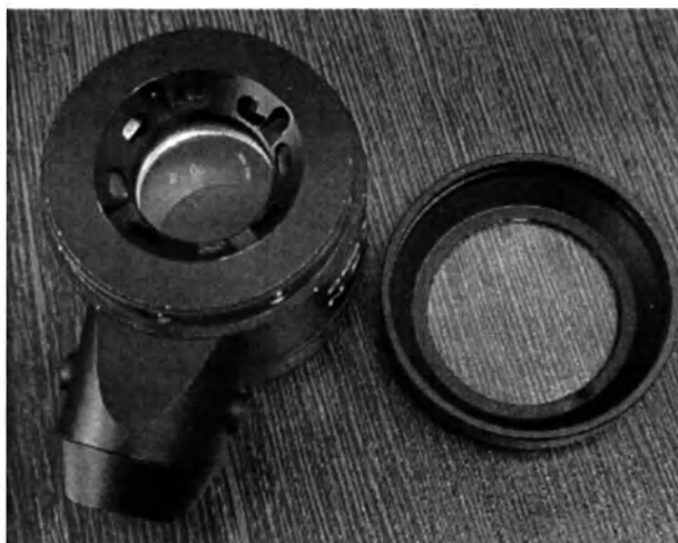
Рис.2. Расположение светодиодов в оптической головке с комбинированным освещением Stern Derma Pro
