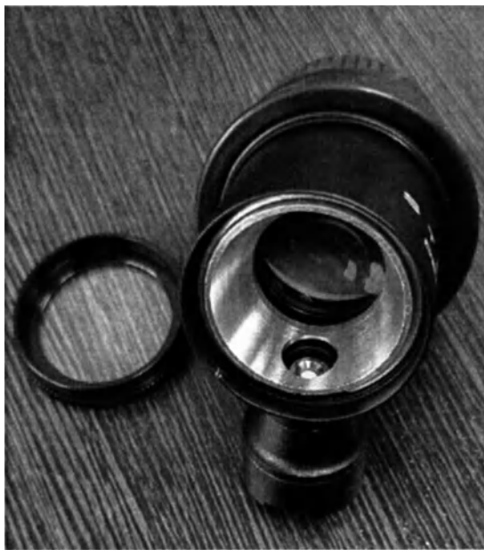
Рис.1. Расположение светодиода в оптической головке с некомбинированным освещением Stern Derma
