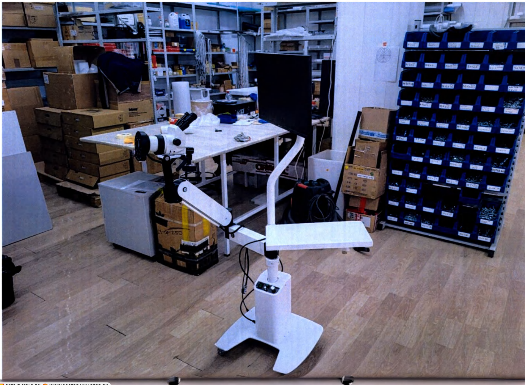
Штатив пантографического типа, с кронштейном для лотка и стойкой под монитор, с блоком питания и основанием колесным
