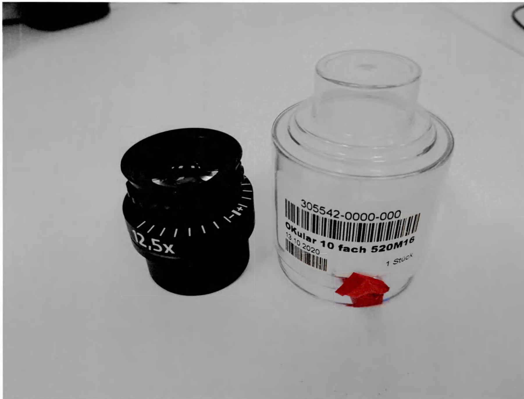
11. Система офтальмологическая лазерная VISUMAX модель 800 - Окуляры тубуса 12.5x с окулярной сеткой и без
