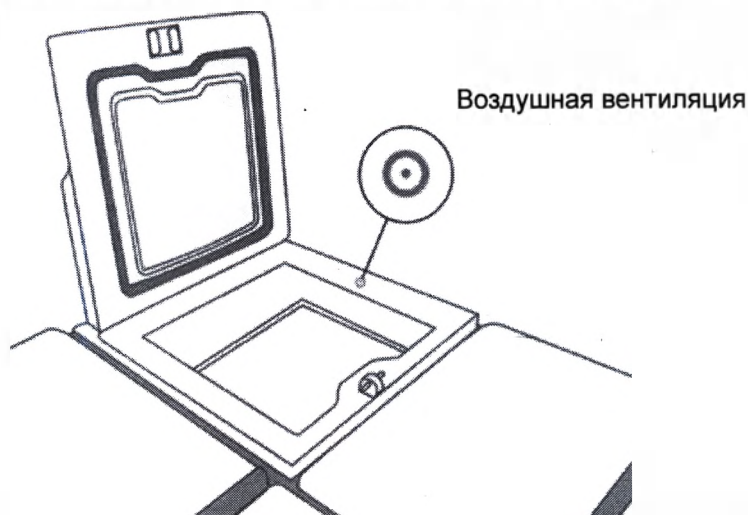
Рисунок 63. Вентиляционное отверстие емкости для парафина
