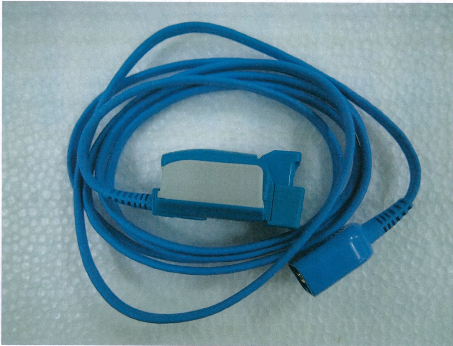
Рисунок 13. Датчик SpO2 пальцевой многожильный
