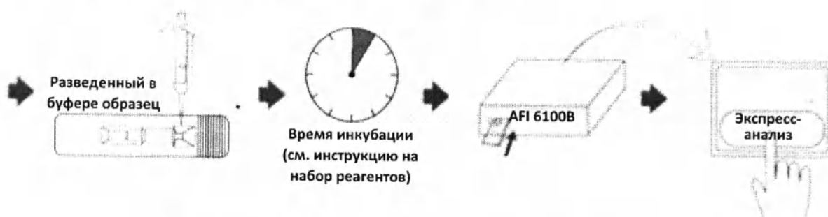
Рисунок 12. Схема проведения экспресс-анализа (немедленный тест)
