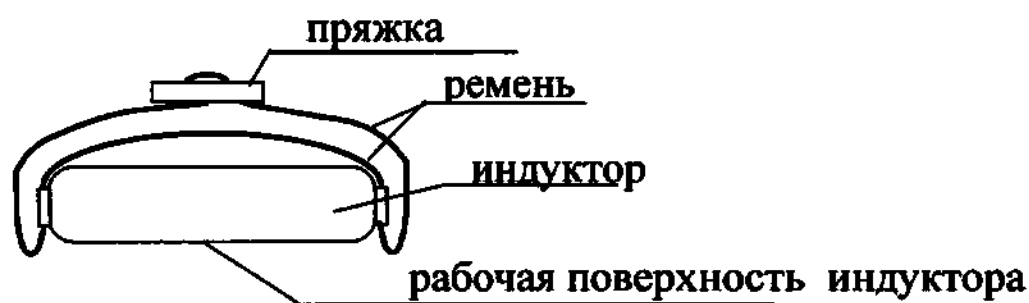
Рисунок 2 - Схема крепления фиксирующего ремня на индукторе
