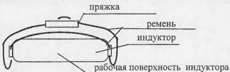
Рисунок 2 – Схема крепления фиксирующего ремня на индукторе
