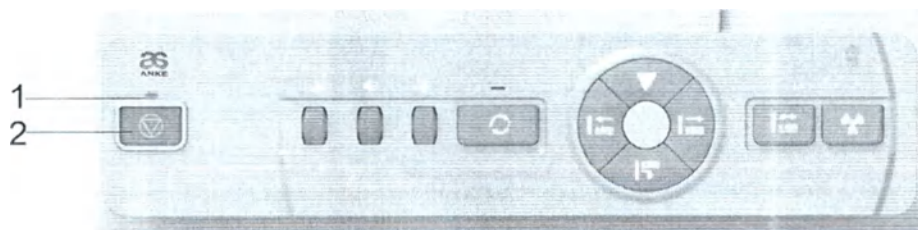
Рисунок 4. 1- световой индикатор аварийного выключения, 2 -кнопка аварийного выключения на блоке управления со встроенной системой интерком
