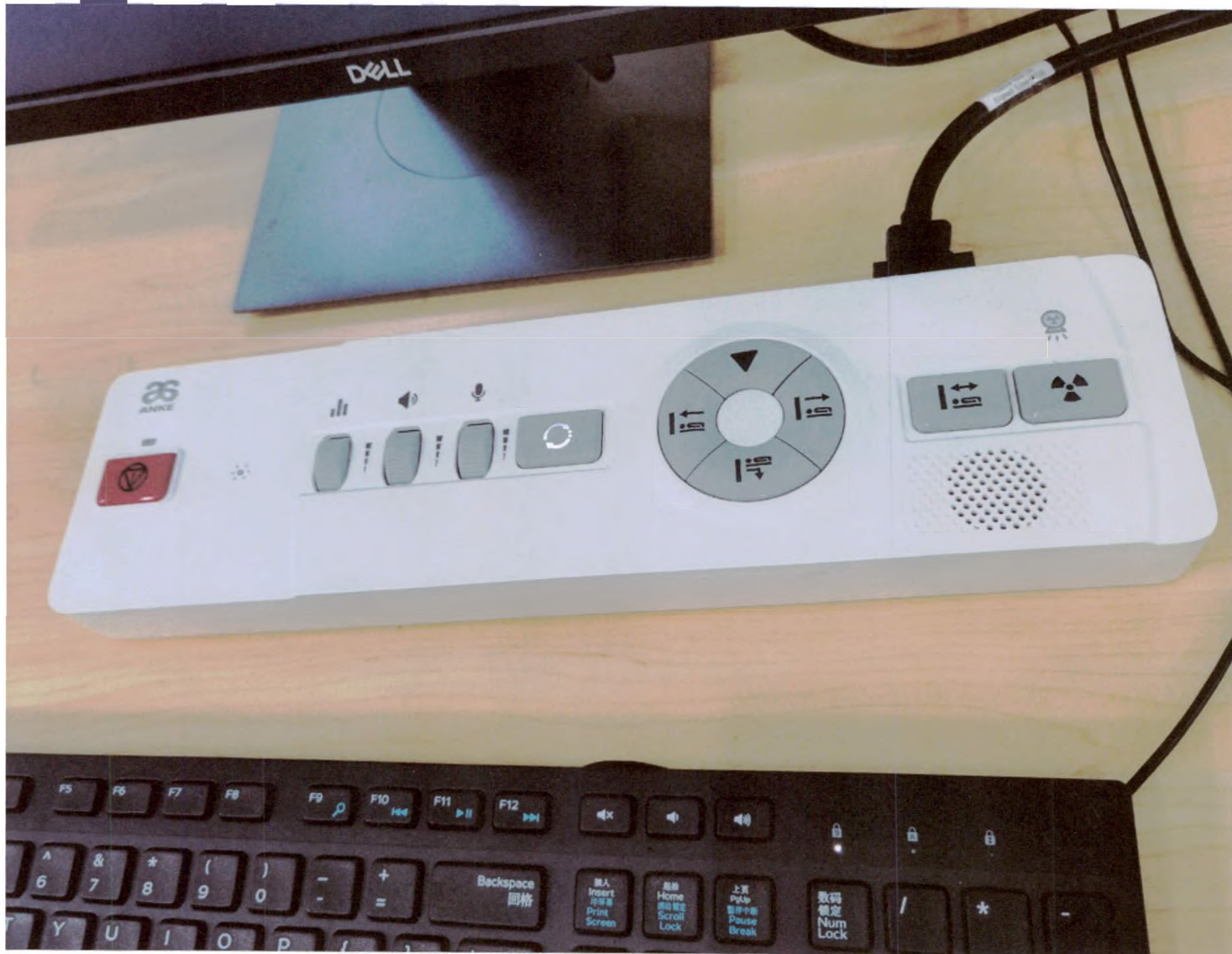
Блок управления со встроенной системой интерком
