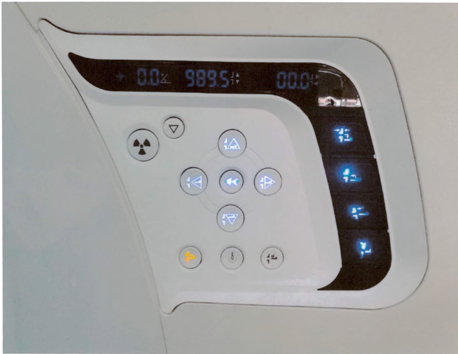
Панель управления гентри (Модель: P001910/ P001911)
