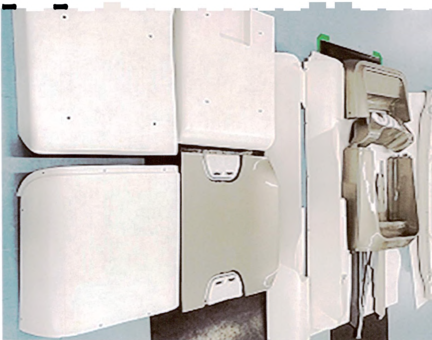
Кожухи для стола снимков (Только для Варианта 1)
