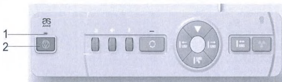
Рисунок 4. 1- световой индикатор аварийного выключения, 2 -кнопка аварийного выключения на блоке управления со встроенной системой интерком
