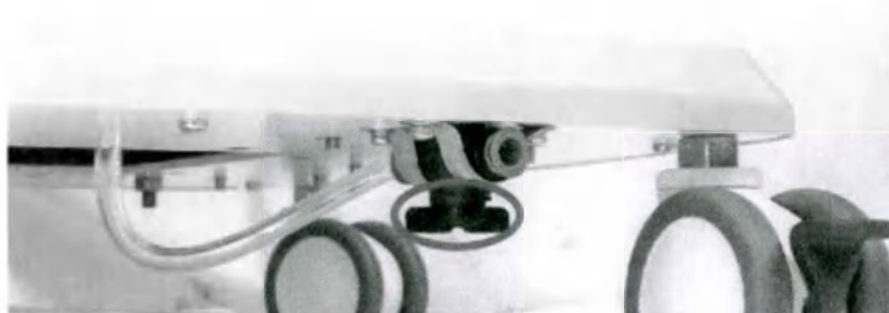
Рисунок 27. Удаление конденсата из воздушного компрессора.
