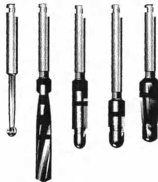
Направляющая фреза, спиральная фреза, пилотная фреза, кортикальная фреза, коническая фреза (слева направо)
