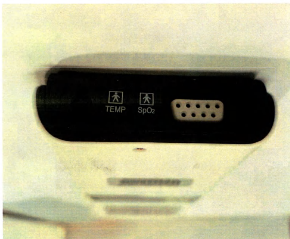
Рис.11 Внешний вид варианта исполнения SP-20. Разъемы для подключения датчика насыщения крови кислородом SpO_2 и температуры (датчик температуры -не применимо на территории РФ)
