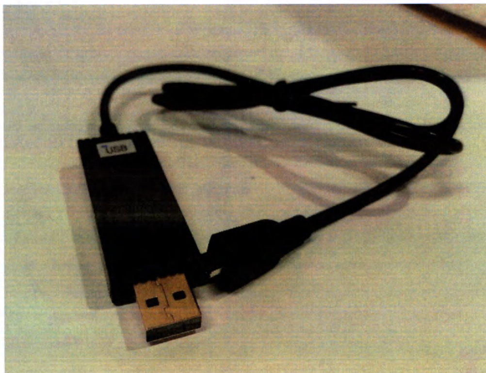
Рис. 5 USB кабель передачи данных (при необходимости), модель USB-A/Type-C, производства Weixunda Electronic Products Co., Ltd.
