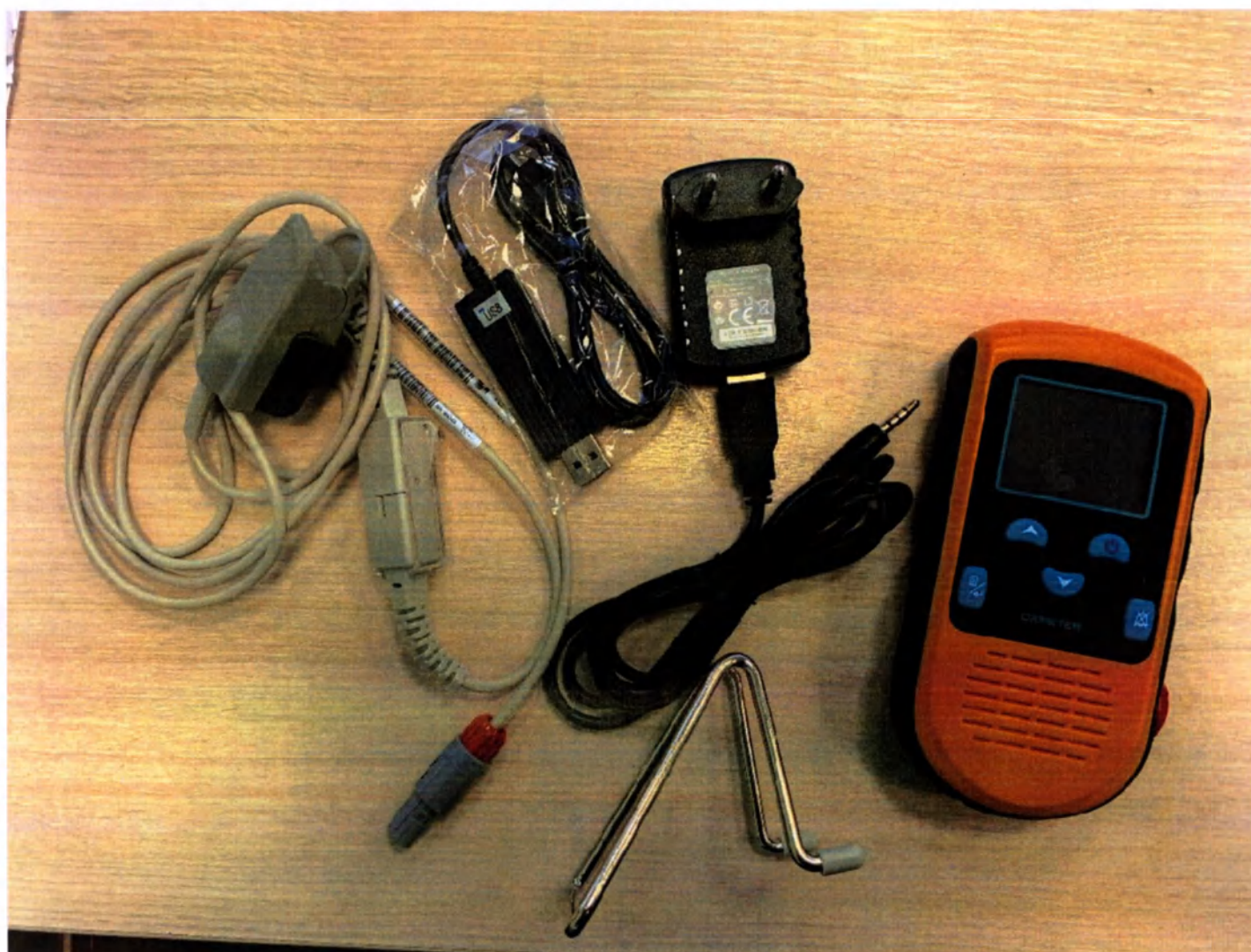
Рис. 3 Общий вид комплекта поставки варианта исполнения PC-66B. Блок основной PC-66B, Датчик насыщения крови кислородом SpO 2 , модель KS-C01, производства Shenzhen Creative Industry Co., Ltd., Держатель, Адаптер питания, модель LXCP12-005120BEG, производства Shenzhen Longxc Power Supply Co., Ltd, USB кабель передачи данных (при необходимости), модель USB-A/Type-C, производства Weixunda Electronic Products Co., Ltd.
