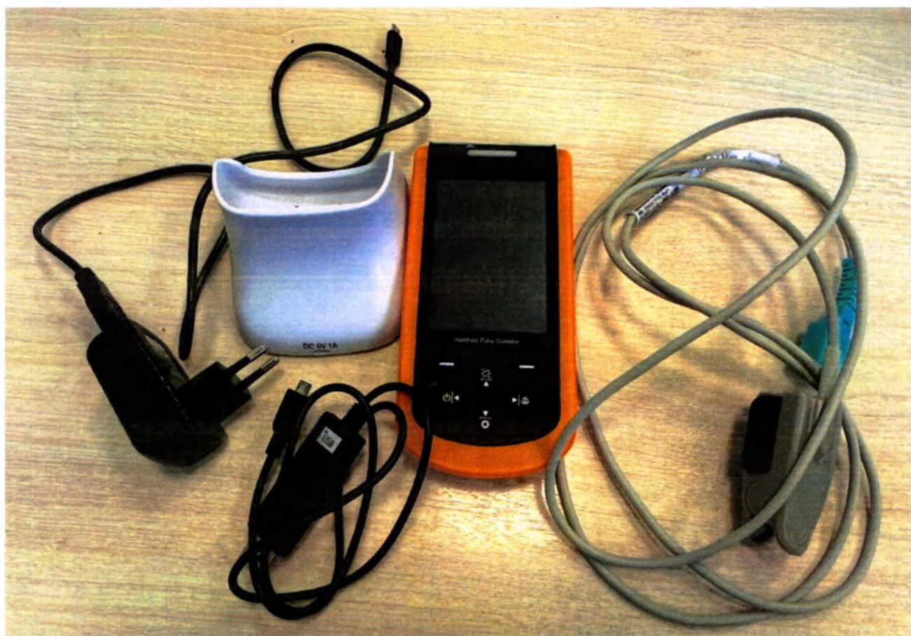
Рис. 8 Общий вид комплекта поставки варианта исполнения SP-20. Блок основной SP-20, Датчик насыщения крови кислородом \text{SpO}_2 , модель KS-AC01, производства Shenzhen Creative Industry Co., Ltd, Резиновый чехол для основного блока, Зарядная станция, модель SP-20, Адаптер питания, модель LXCP12-005120BEG, производства Shenzhen Longxc Power Supply Co., Ltd., USB кабель передачи данных (при необходимости), модель USB-A/Type-C, производства Weixunda Electronic Products Co., Ltd.
