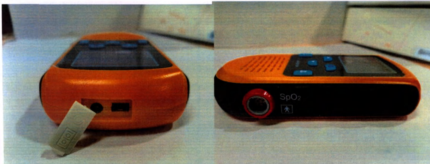
Рис. 2 Внешний вид варианта исполнения PC-66B. Разъемы подключения USB кабеля передачи данных, адаптера питания и датчика насыщения крови кислородом SpO 2
