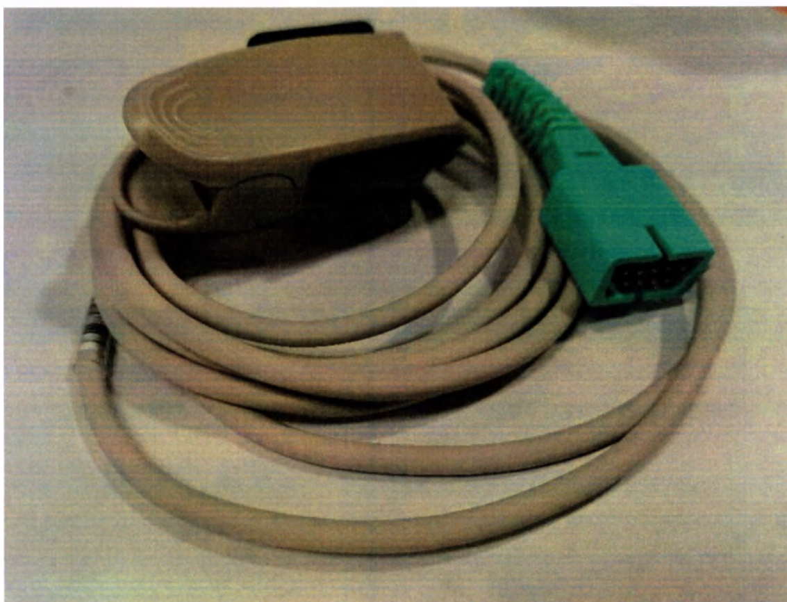
Рис. 12 Внешний вид варианта исполнения SP-20. Датчик насыщения крови кислородом \text{SpO}_2 , модель KS-AC01, производства Shenzhen Creative Industry Co., Ltd
