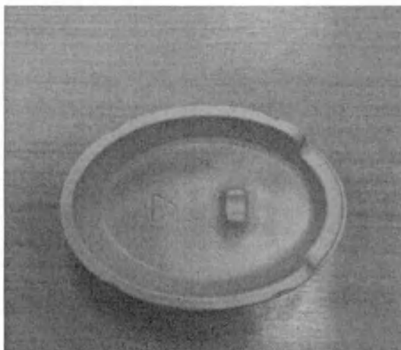
Рис.12 Лоток для тестирования пневматического ножа
