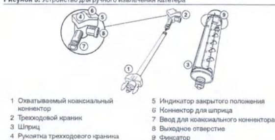
Рисунок 3. Устройство для ручного извлечения катетера
