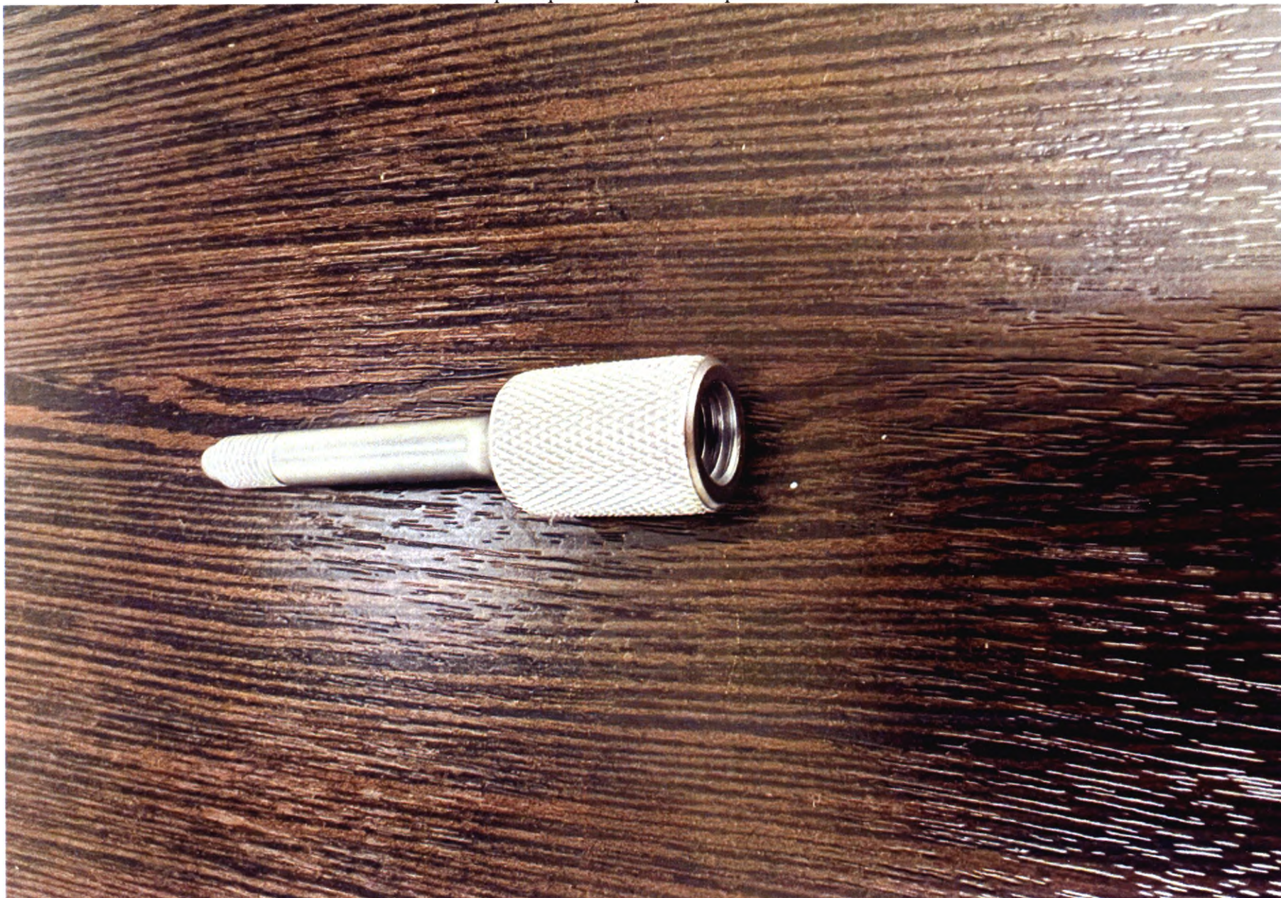
28. Экстрактор ножки/рашпиля резьбовой 1/4-28
