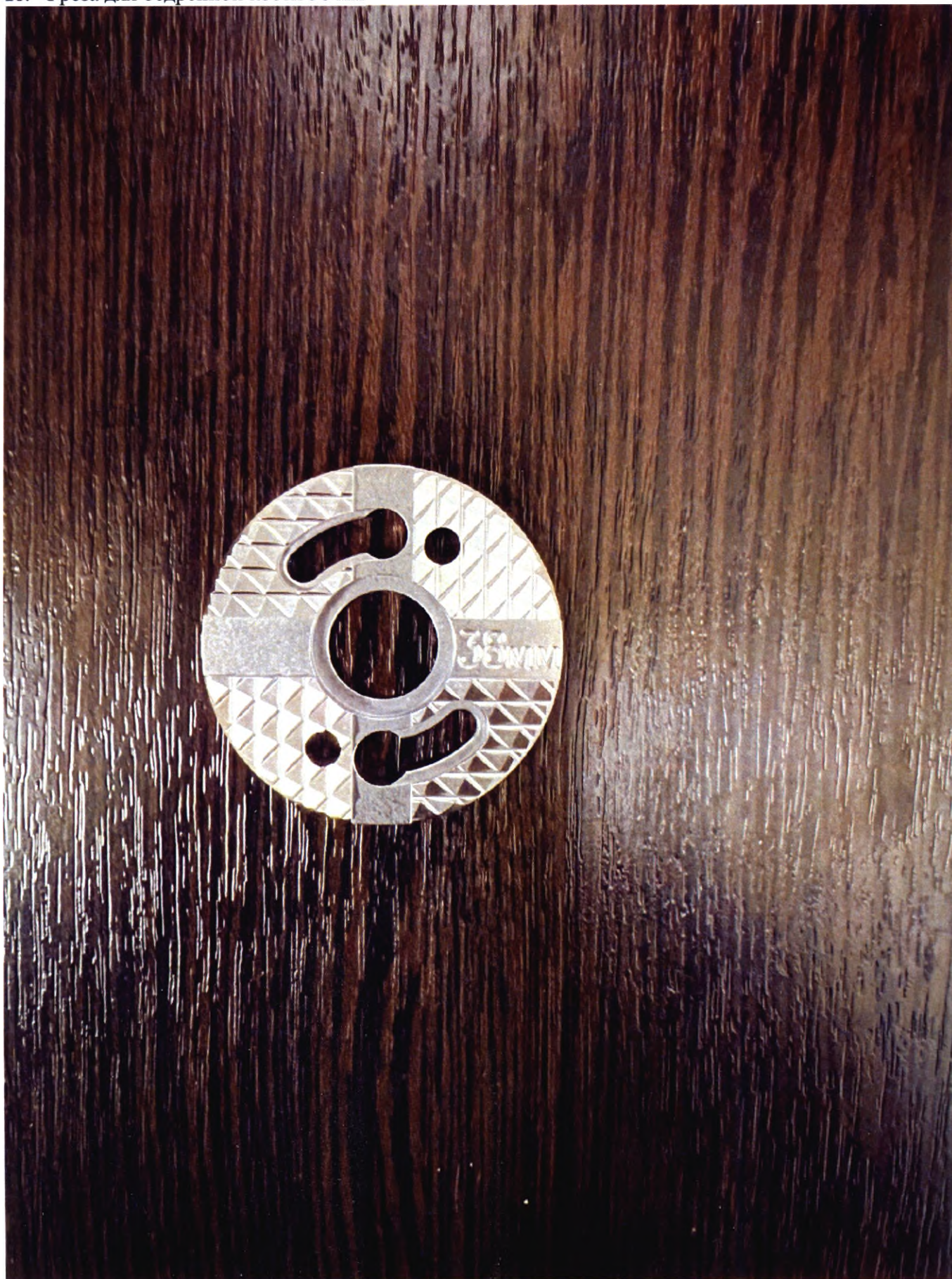
21. Фреза для бедренной кости 38 мм
