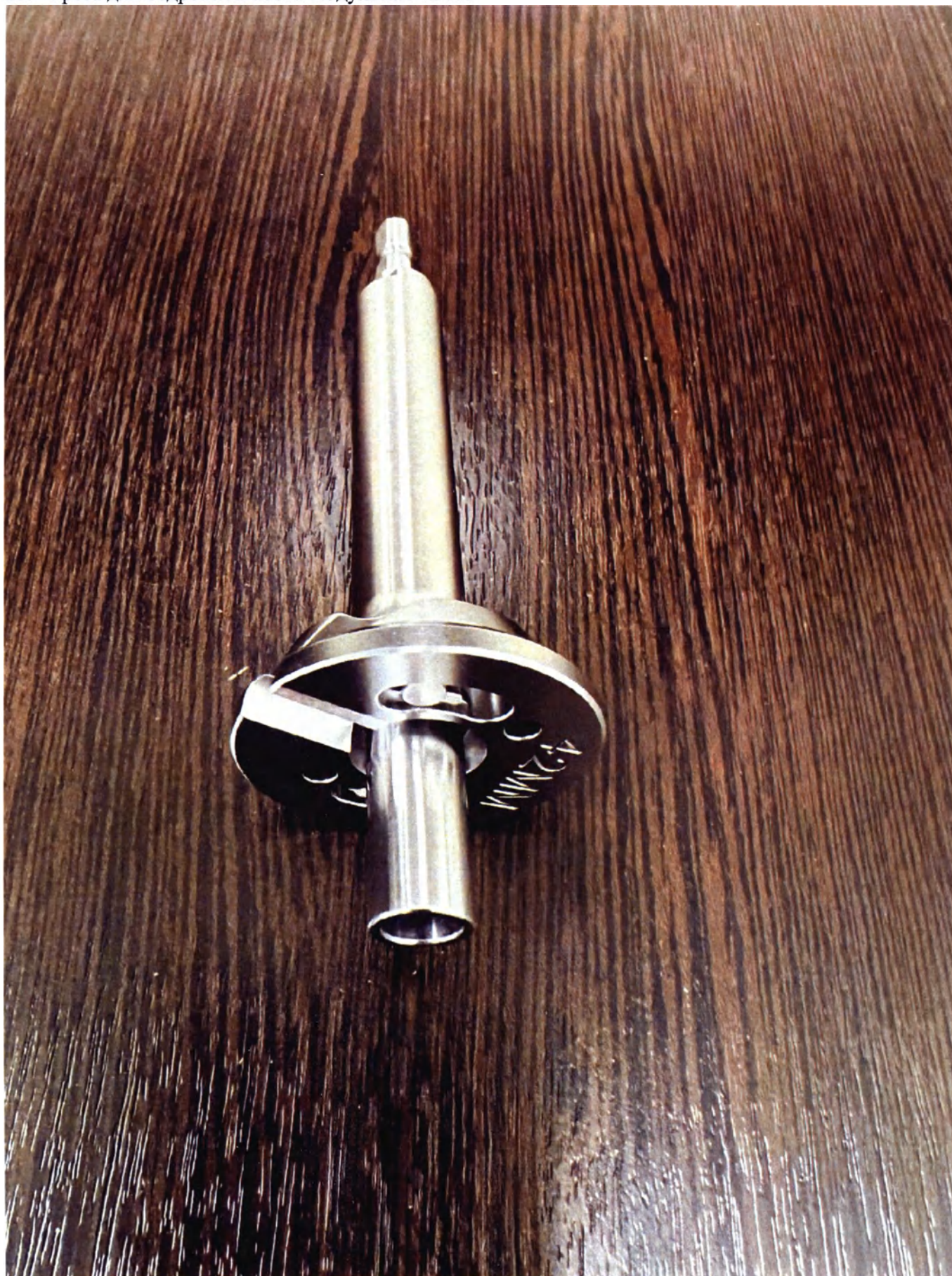
20. Фреза для бедренной кости модульная 42 мм
