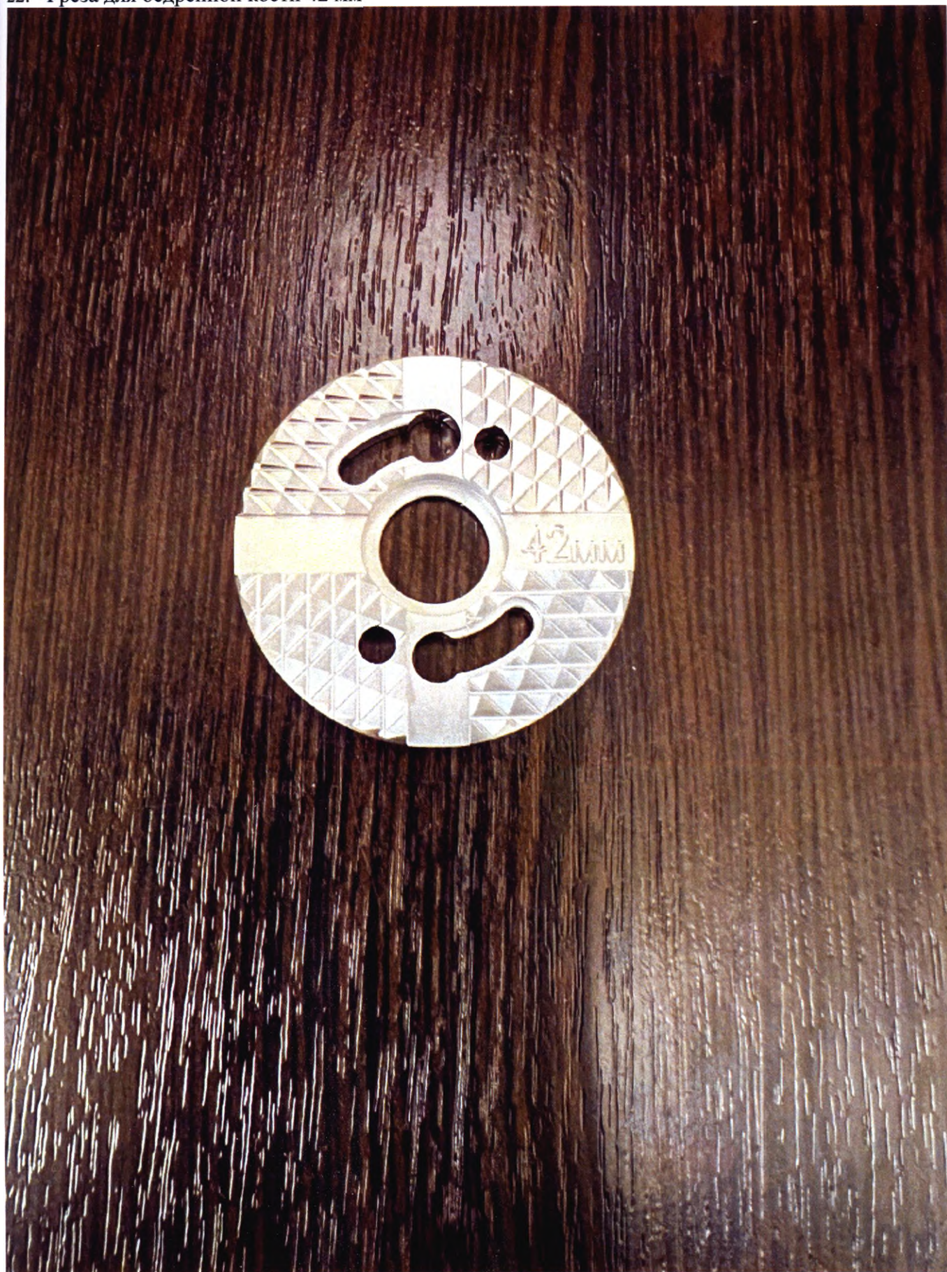
22. Фреза для бедренной кости 42 мм
