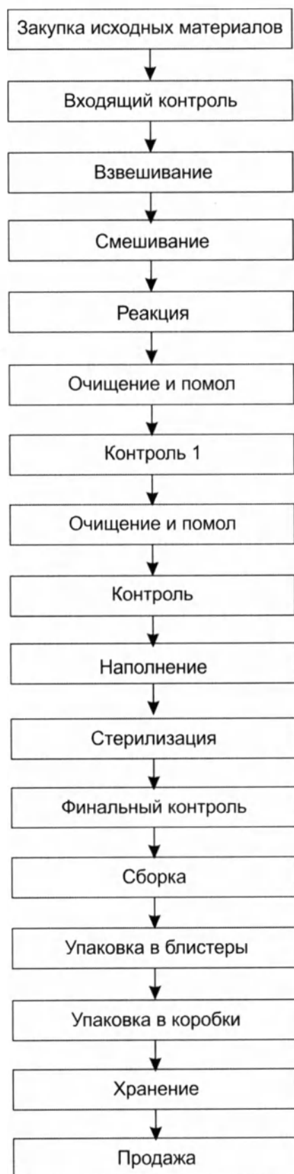
Рис. 12. Схема производственного процесса Elasty Plus
