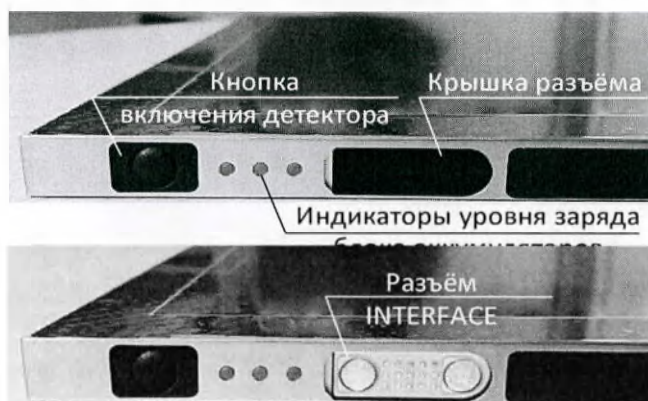
Рисунок 2.6 – Разъем INTERFACE для установки проводного канала связи между беспроводным детектором КЖЛЯ.050.010.00.00.00.000 и АРМ
