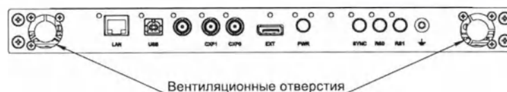
Рисунок 1.14 – Вентиляционные отверстия в нижней части корпуса стационарного детектора
