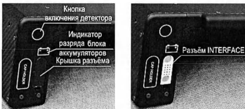
Рисунок 2.6 – Разъем INTERFACE для установки проводного канала связи между беспроводным детектором КЖЛЯ.050.010.00.00.00.000 и АРМ
