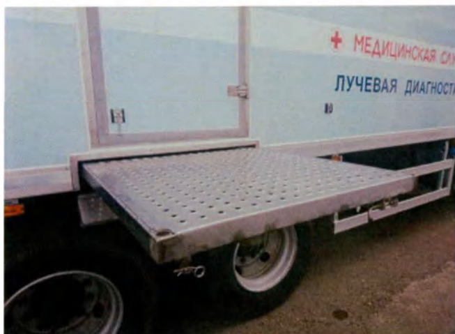
Рисунок 31. Площадка входного трапа.
