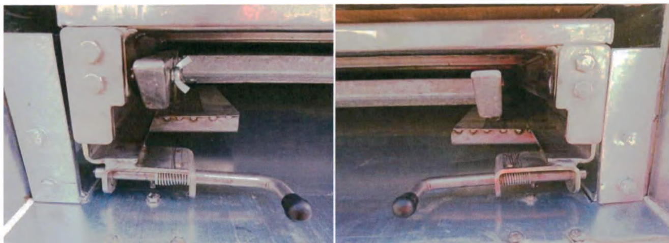
Рисунок 21, 21.1. Передние фиксаторы площадки входного трапа, в открытом положении.
