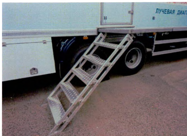
Рисунок 34. Установленный лестничный марш.
