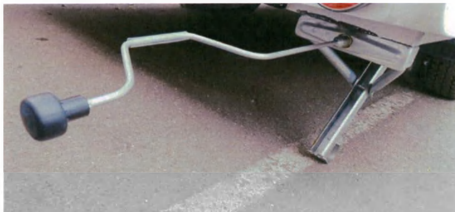
Рисунки 18, 18.1. Установка опор кузова специальным ключом.
