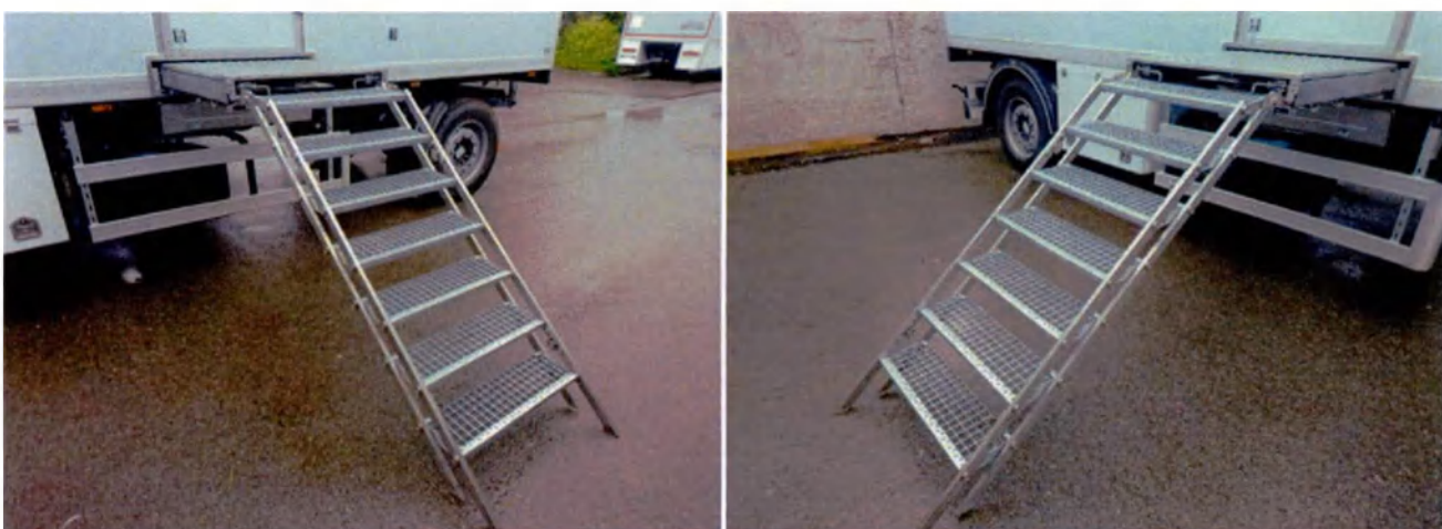
Рисунок 24. Лестничный марш в выдвинутом положении.
