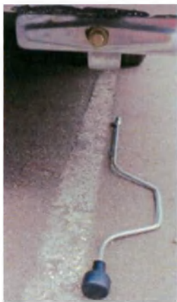
Рисунки 18, 18.1. Установка опор кузова специальным ключом.
