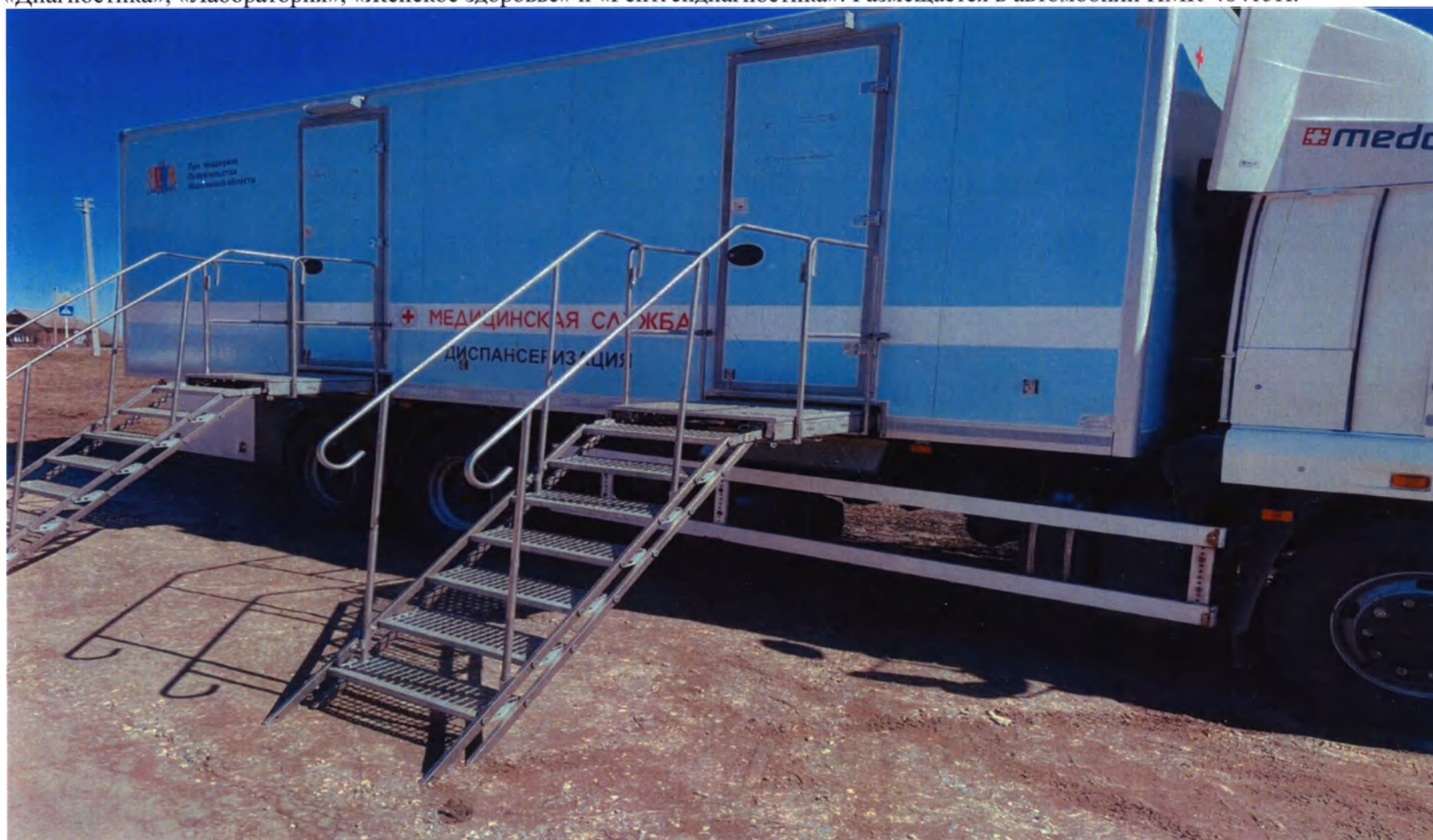
Рисунок 1.3. Комплекс медицинский передвижной «МЕДКАР», вариант исполнения «Диспансеризация», состоит из кабинетов: «Диагностика», «Лаборатория», «Женское здоровье» и «Рентгендиагностика». Размещается в автомобиле ПМК-48415Н.
