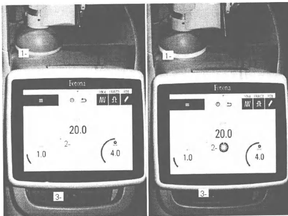
Рисунок 3.5: слева: система в режиме ОЖИДАНИЯ: Кнопка Ожидания/готовности (Ready/Standby) серая и индикатор излучения не горит. Справа: система в режиме ГОТОВНОСТИ: кнопка Ready/Standby красная и индикатор излучения горит.
