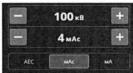
Рисунок 3.22 – Параметры рентгенографии при двухточечном режиме экспозиции
