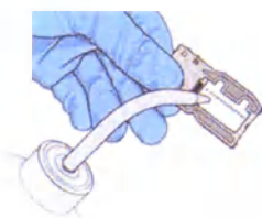
Рис. 5 Промывка проточной кюветы
