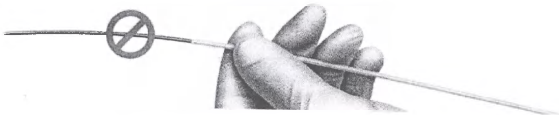
Рисунок 8. Удерживание стабилизационной гильзы ЗАПРЕЩАЕТСЯ удерживать или касаться передвижной гильзы темного цвета
