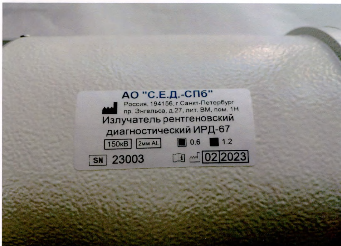
Фотография 16 – Маркировка излучателя рентгеновского серии ИРД, АО «С.Е.Д.-СПб»
