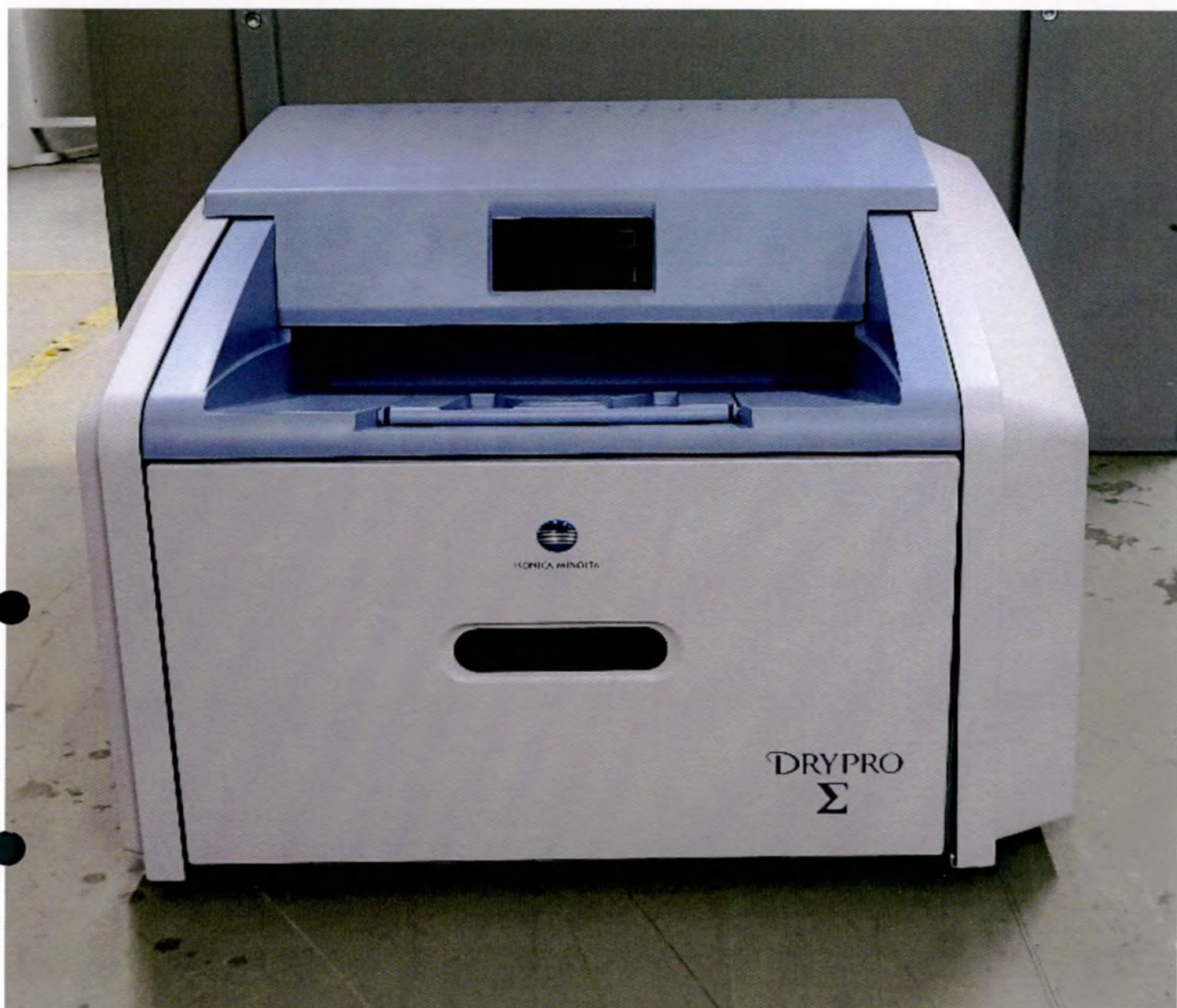
Фотография 65 – Камера лазерная мультиформатная серии DRYPRO
