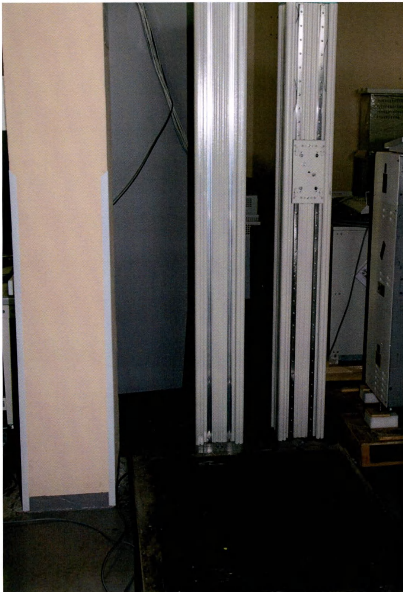
Фотография 30 – Колонна с направляющими серии SUR-20 включающей профиль 201 030 9300, FOSHAN ZP ALUMINUM CO., LTD, Китай или ZP GROUP CO., LIMITED, Китай
