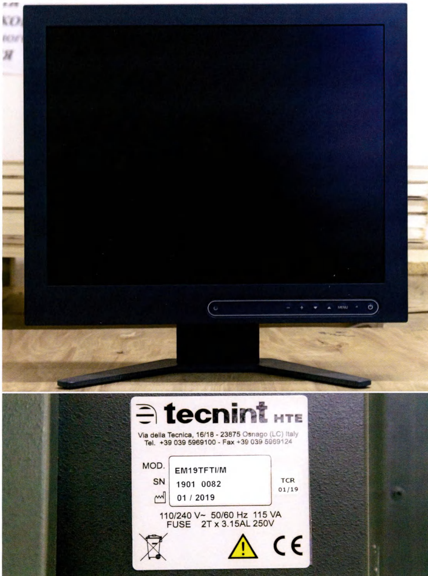
Фотография 77 – Монитор серии EM (вариант внешнего вида), Tecnint HTE s.r.l., Италия и маркировка
