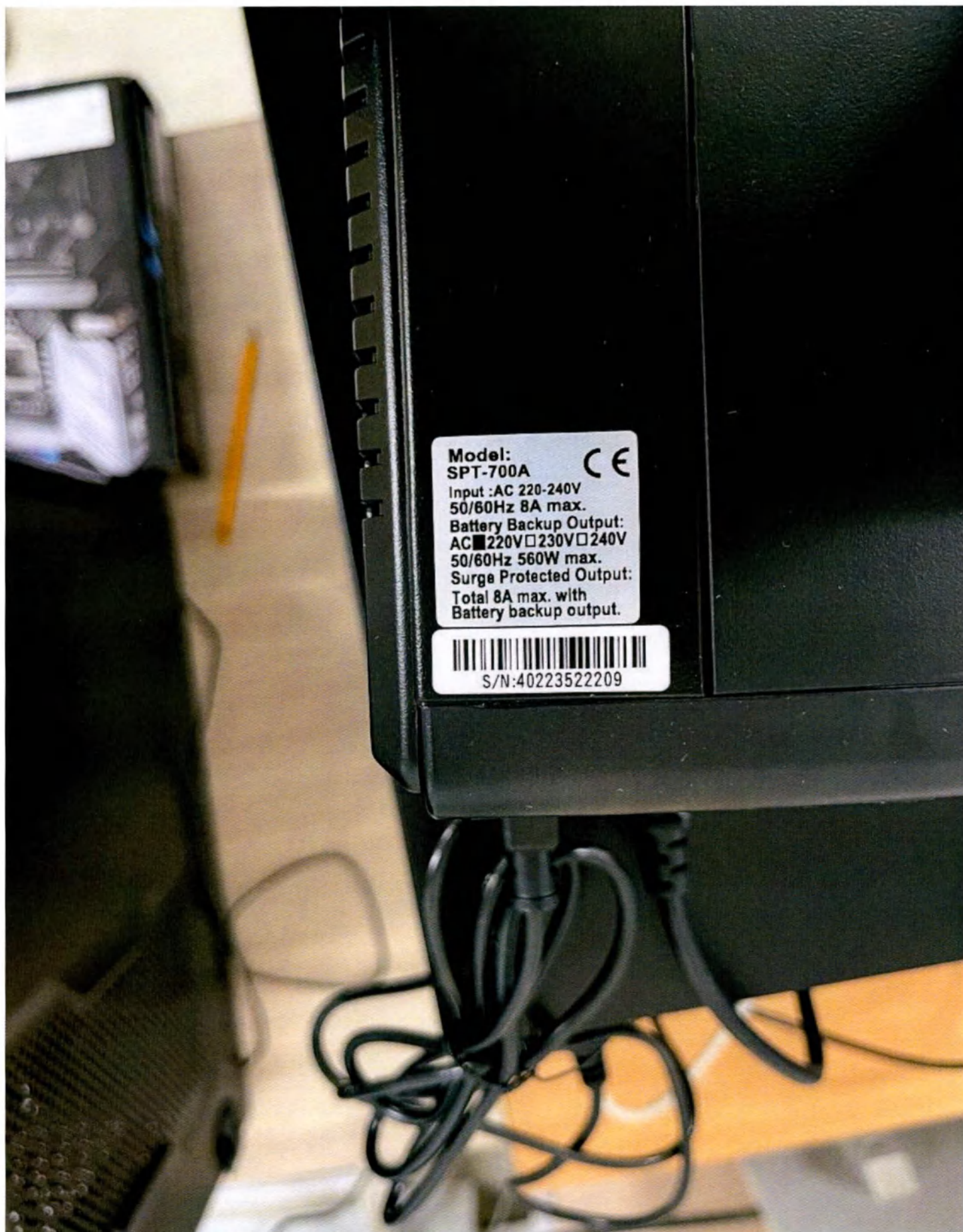
Фотография 87 – Источник бесперебойного питания серии SPT, POWERCOM CO., Маркировка
