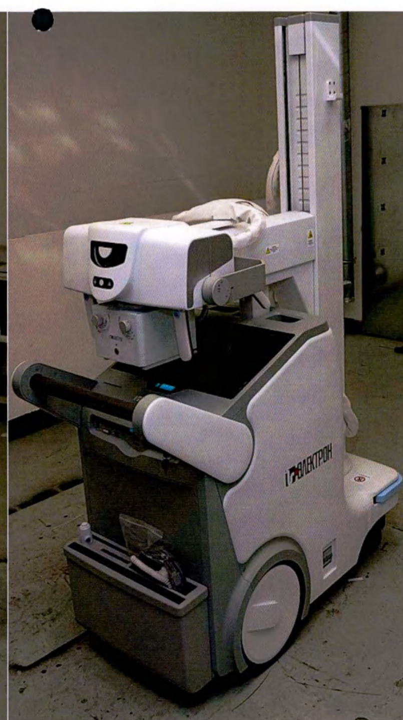
Фотография 1.1 – Вариант внешнего вида АПР-ЭКСПЕРТ с Блоком передвижным рентгеновским серии MobileCooper, Shenzhen Browiner Tech Co включающим Систему позиционирования рентгеновскую MC Shenzhen Browiner Tech Co., Ltd, Китай, в рабочем и транспортном положении
