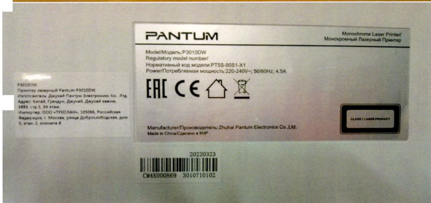
Фотография 58 – Принтер лазерный серии Pantum, производства Zhuhai Pantum Electronics Co Внешний вид и маркировка
