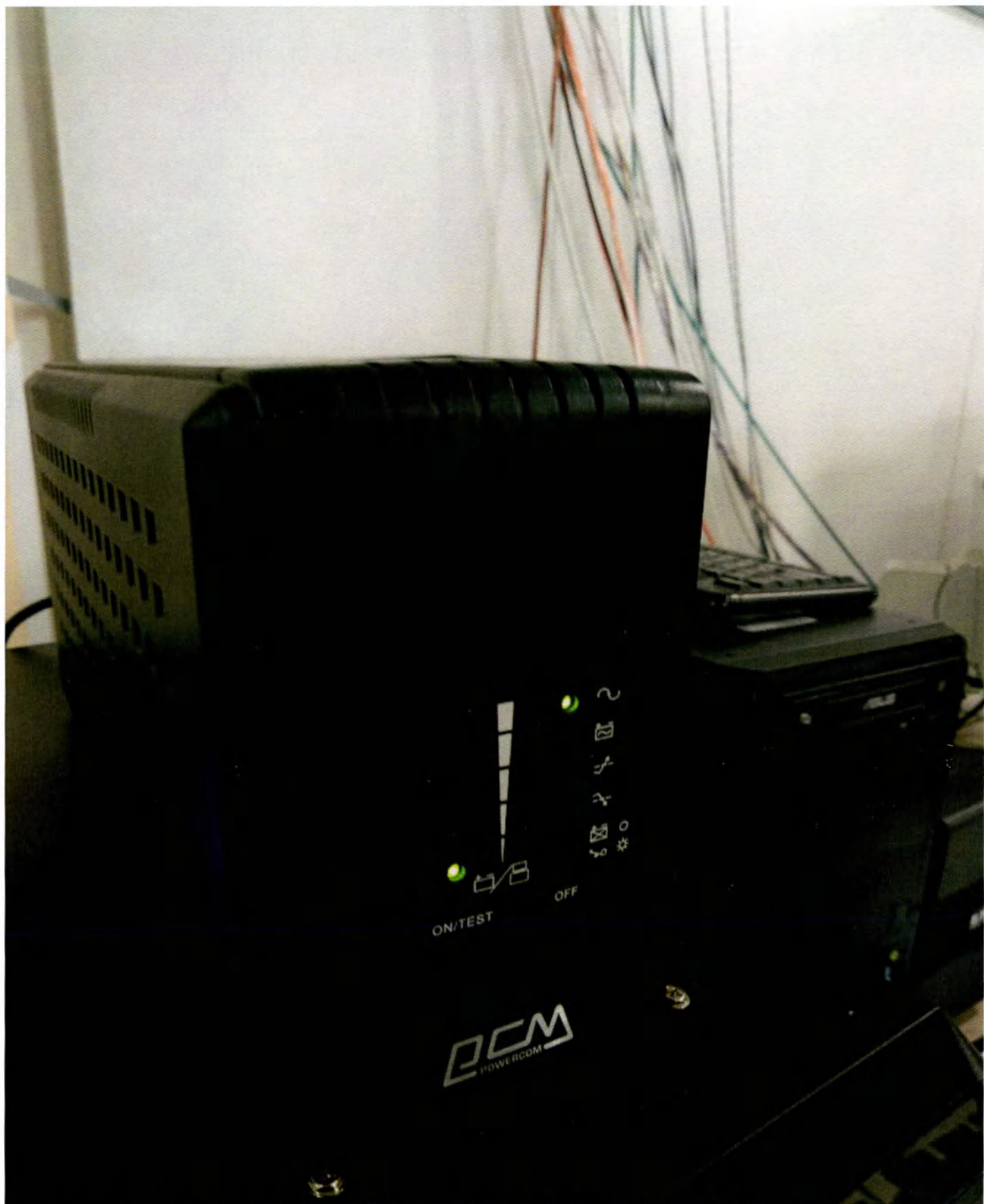
Фотография 86 – Источник бесперебойного питания серии SPT, POWERCOM CO., Ltd Тайвань
