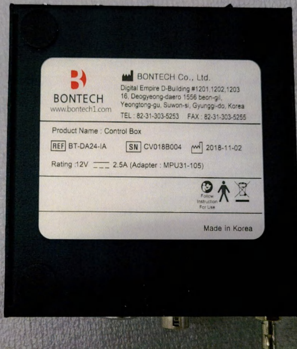
Фотография 53 – Блок управления детектора BONTECH Co., Ltd, Республика Корея и его маркировка
