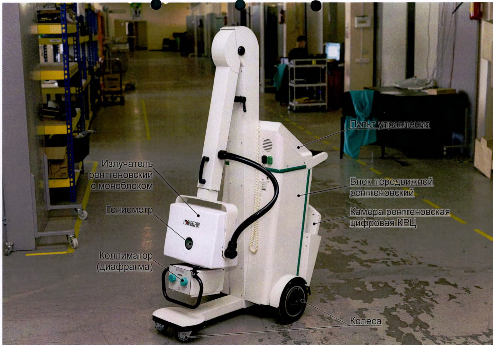
Фотография 2 – Аппарат палатный рентгенографический АПР, исполнение АПР-МАКСИМА (вариант внешнего вида с указанием основных узлов) по спецификации с Блоком передвижным рентгеновским серии Jolly, BMI Biomedical International srl., Италия
