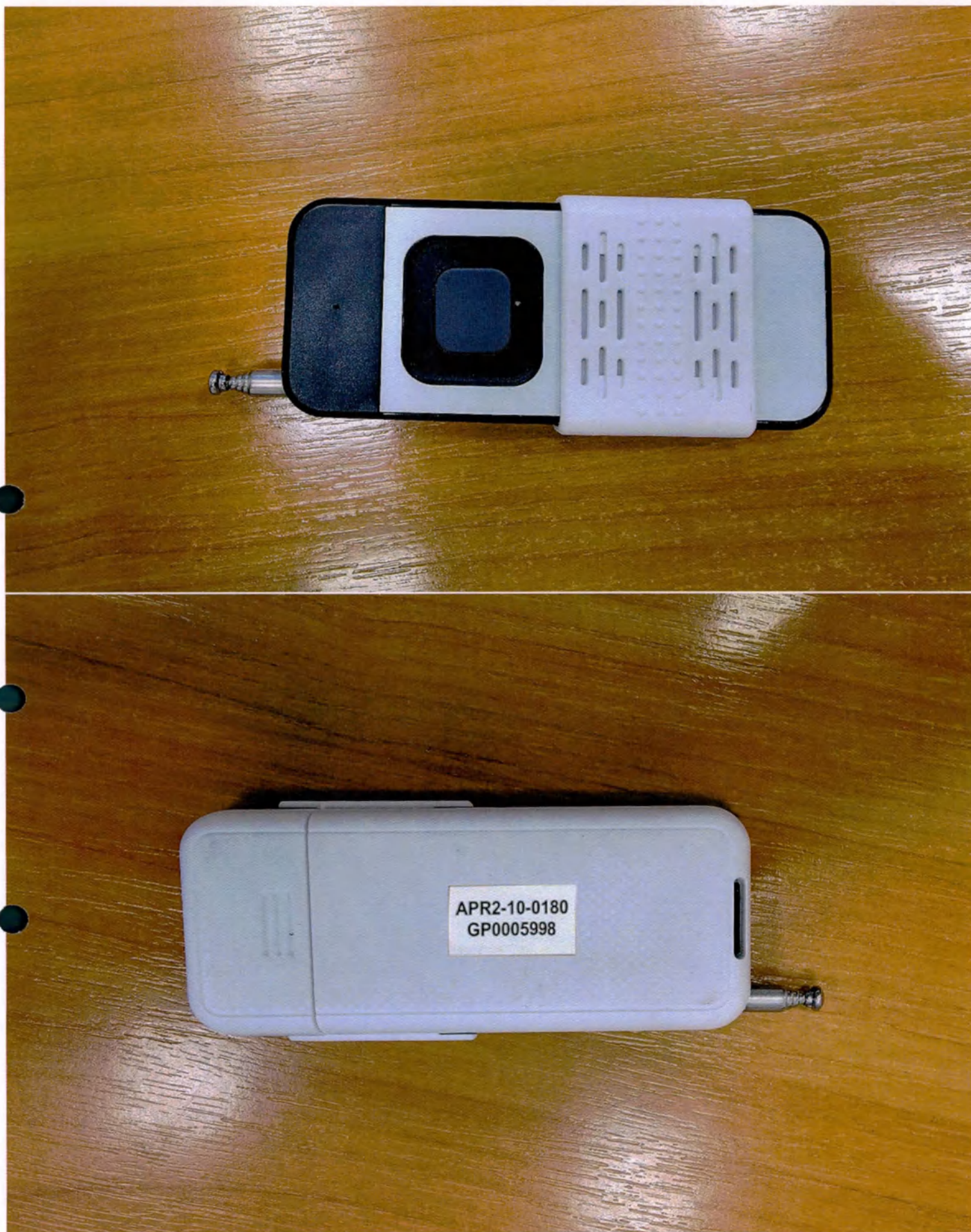
Фотография 24.1 – Двухкносовая кнопка управления экспозицией APR2-10-0180 (вариант внешнего вида) и маркировка
