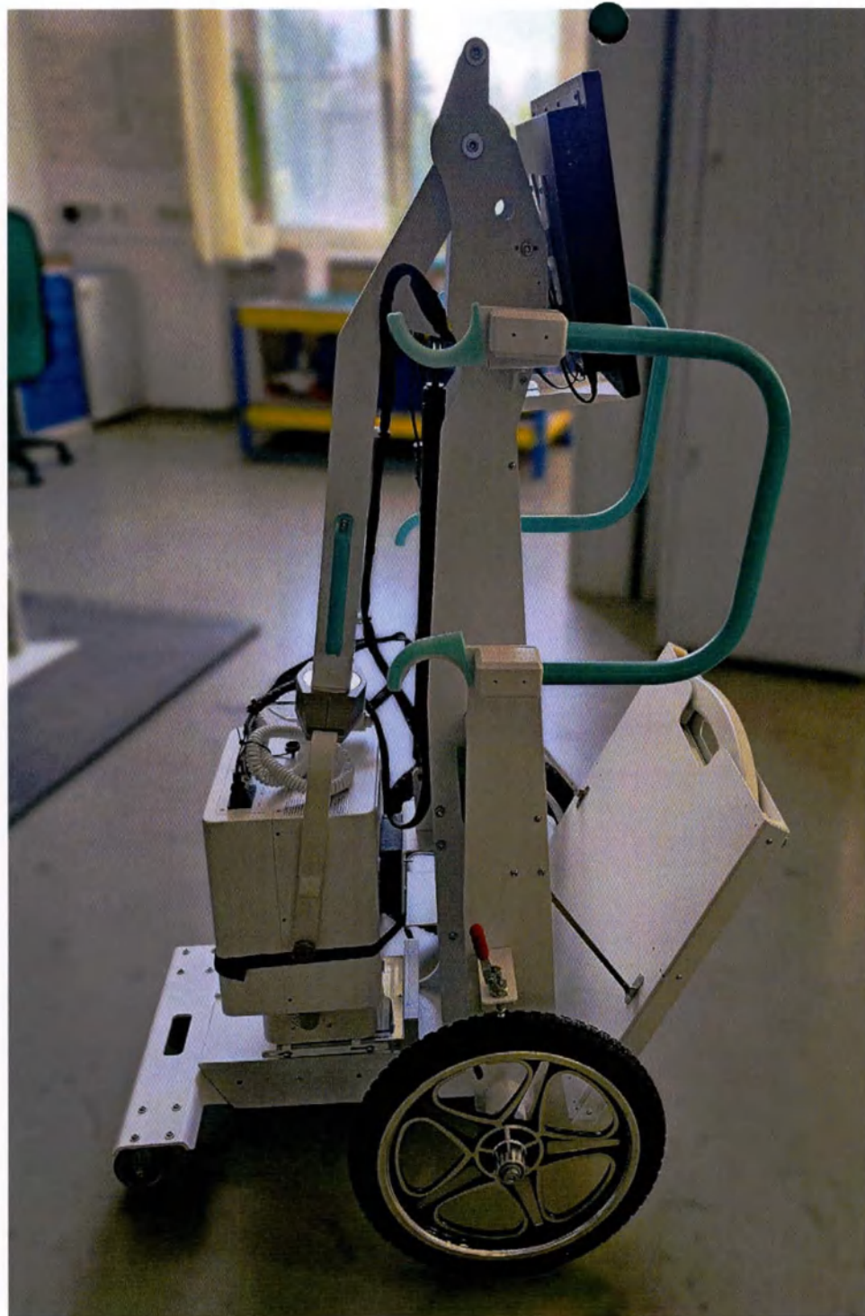
Фотография 1.2 – Вариант внешнего вида АПР-ЭКСПЕРТ, в составе с Блоком передвижным рентгеновским АР2-00 по спецификации, в рабочем и транспортном положении
