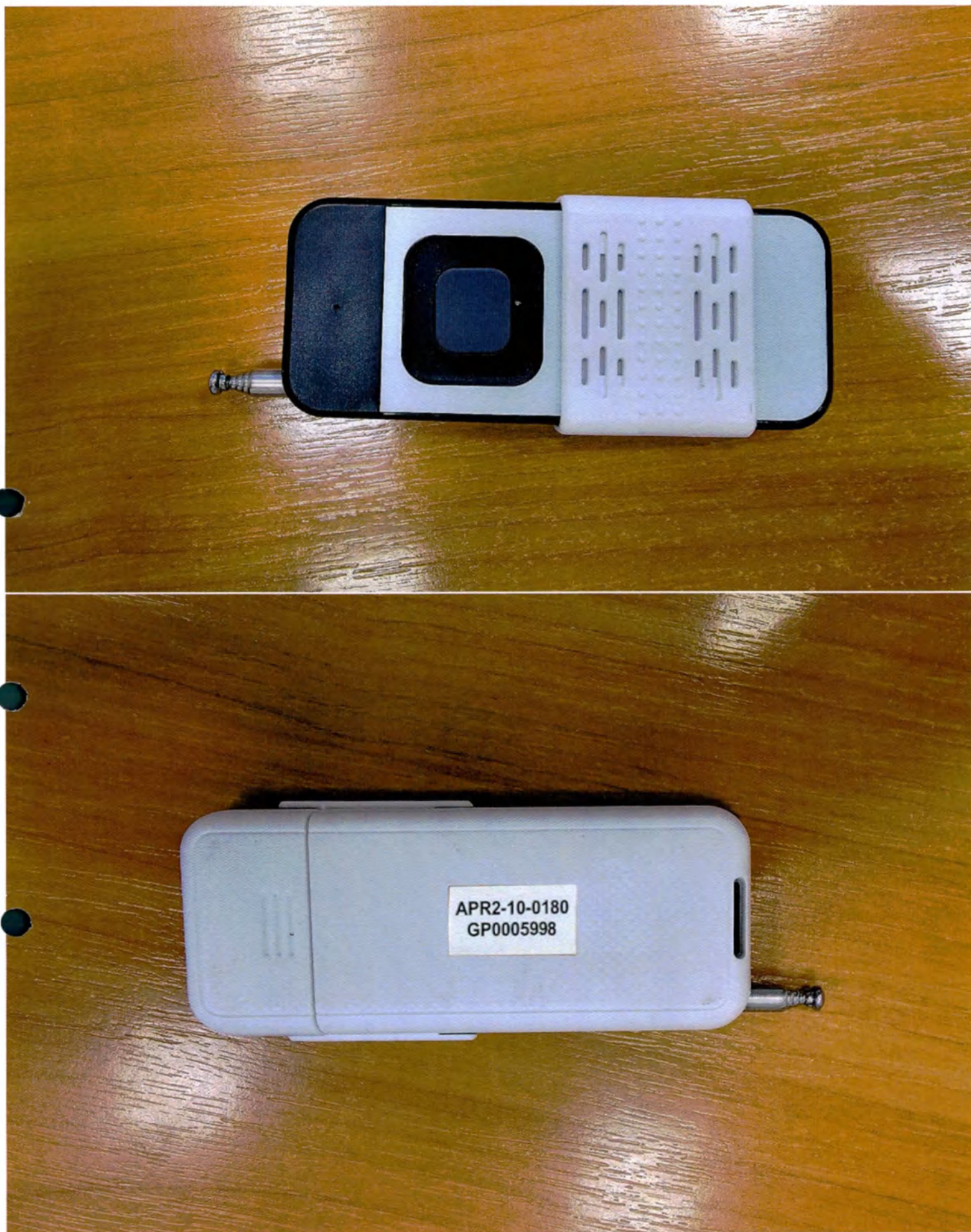
Фотография 25.1 – Двухходовая кнопка управления экспозицией APR2-10-0180 (вариант внешнего вида) и маркировка
