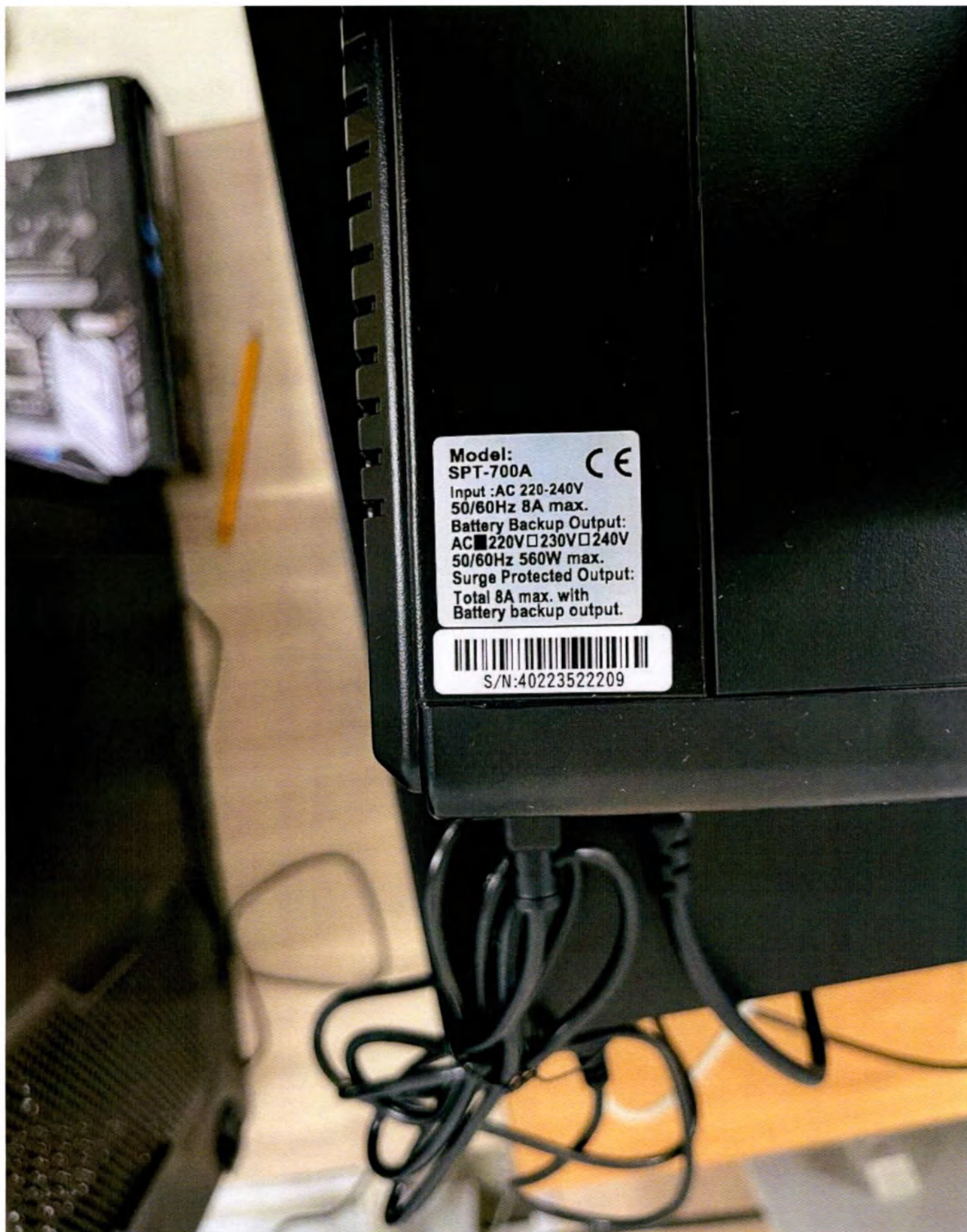
Фотография 88 – Источник бесперебойного питания серии SPT, POWERCOM CO., Маркировка
