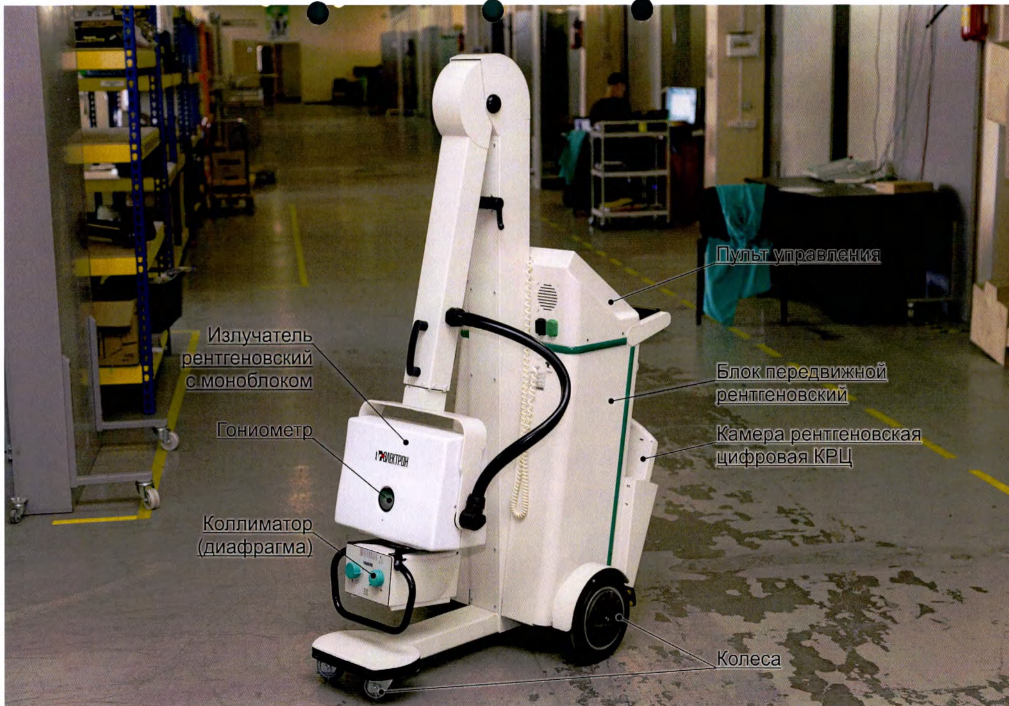
Фотография 2 – Аппарат палатный рентгенографический АПР, исполнение АПР-ЭКСПЕРТ (вариант внешнего вида с указанием основных узлов) по спецификации с Блоком передвижным рентгеновским серии Jolly, BMI Biomedical International srl., Италия
