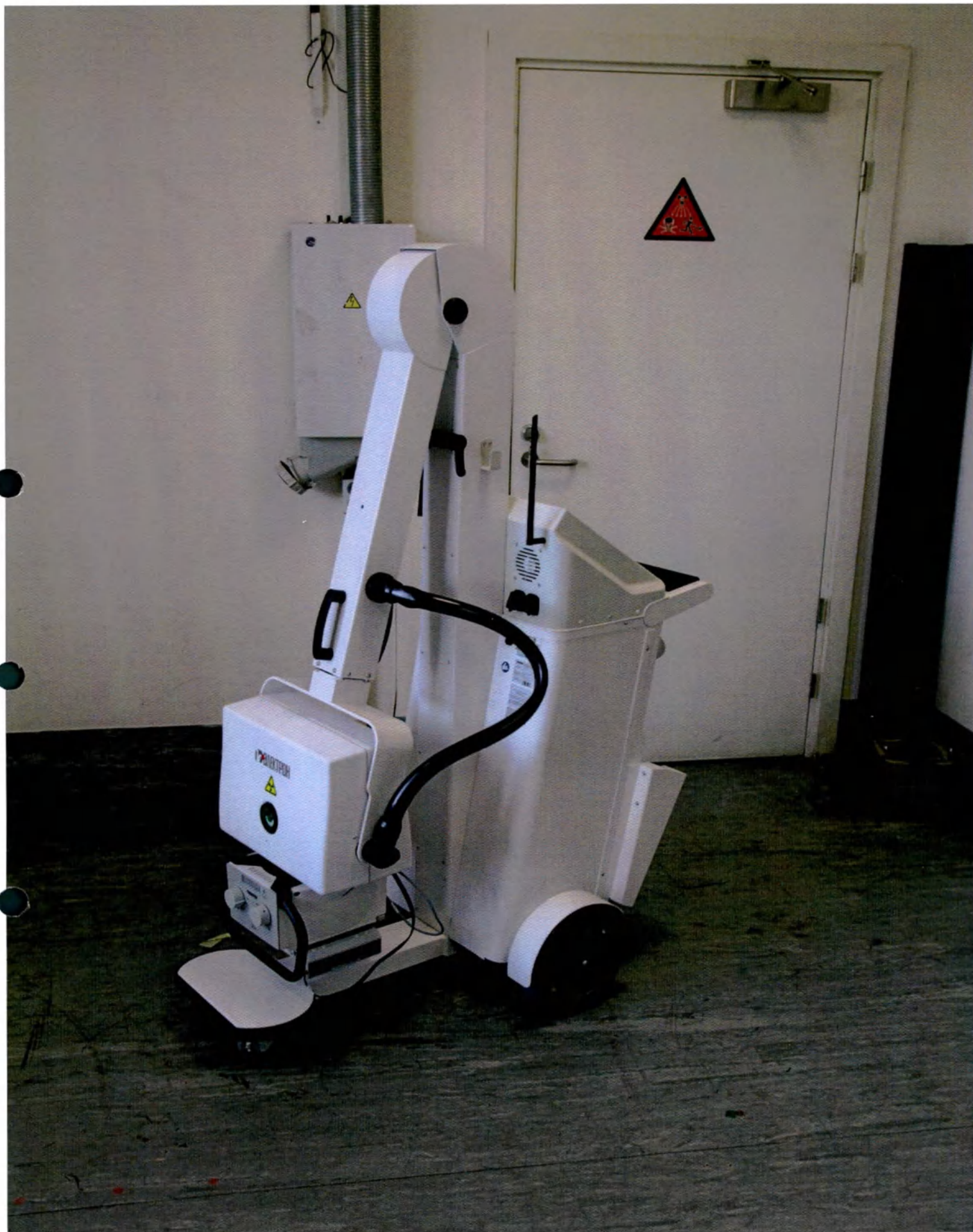
Фотография 3 – Аппарат палатный рентгенографический АПР, исполнение АПР-ЭКСПЕРТ (вариант внешнего вида) по спецификации включающей блок передвижной рентгеновский с аппаратом рентгеновским передвижным с высокочастотным генератором серии Mobildrive BMI Biomedical International srl., Италия/РУ № ФСЗ 2012/12129
