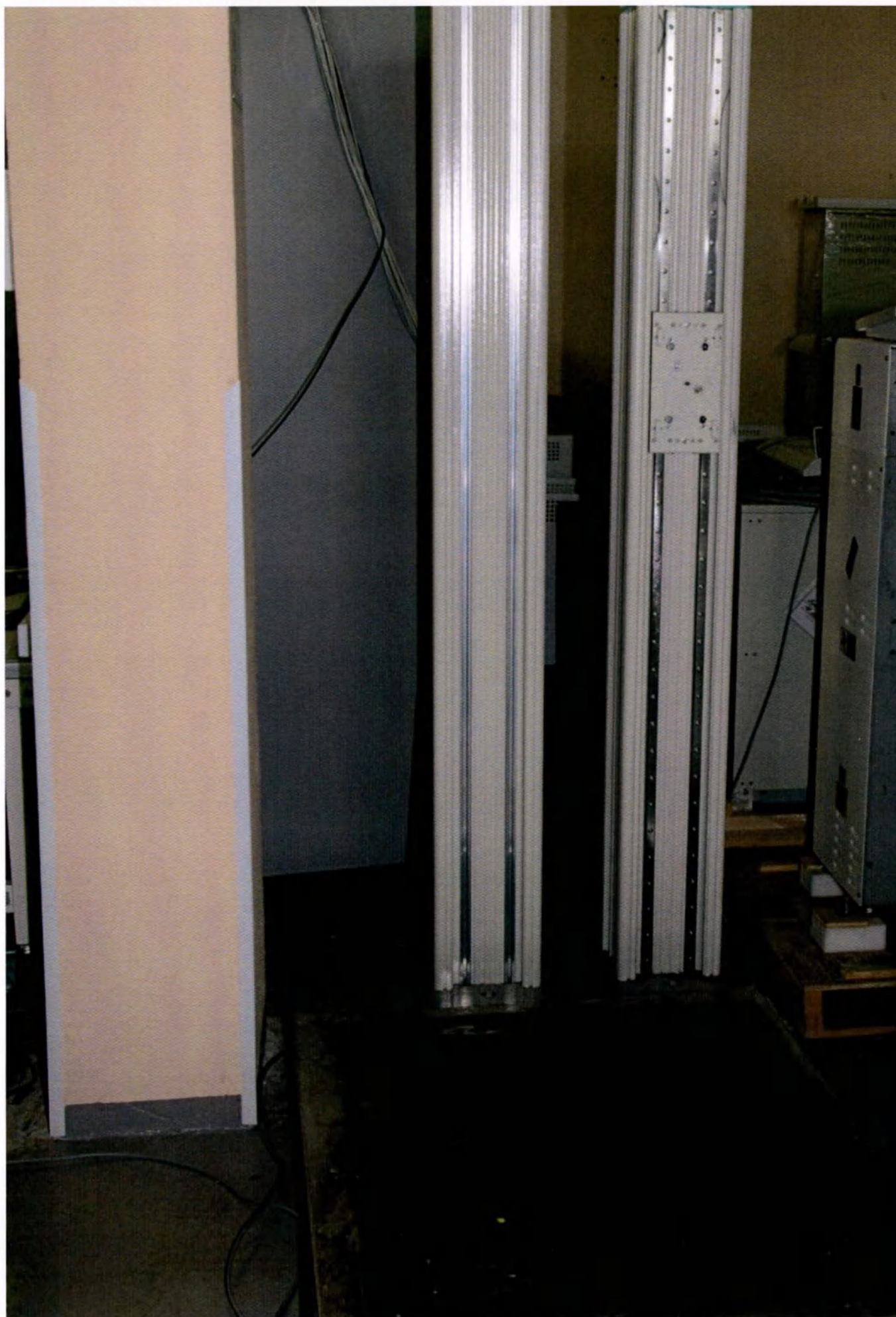
Фотография 31 – Колонна с направляющими серии SUR-20 включающей профиль 201 030 9300, FOSHAN ZP ALUMINUM CO., LTD, Китай или ZP GROUP CO., LIMITED, Китай
