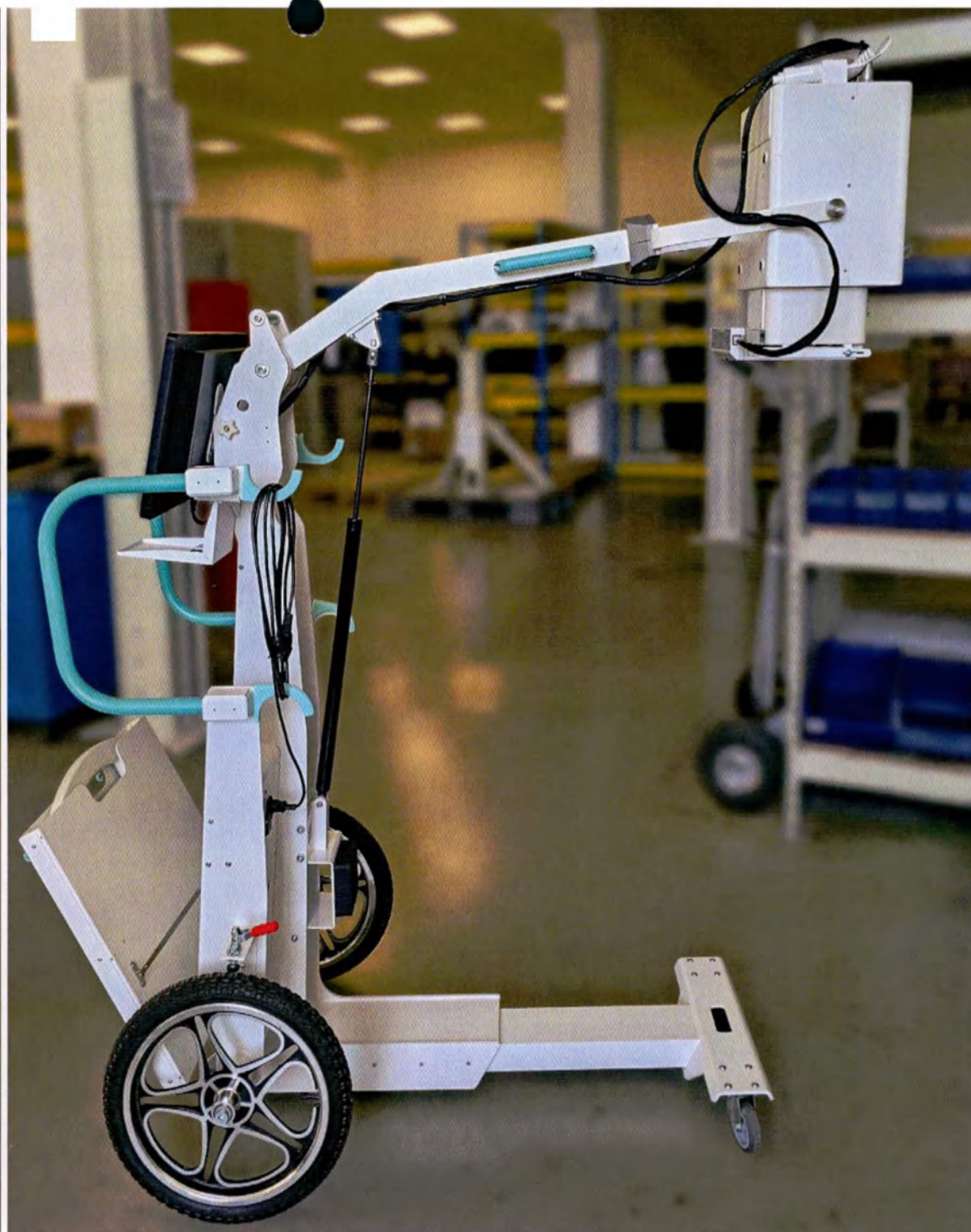
Фотография 1.2 – Вариант внешнего вида АПР-ЭКСПЕРТ, в составе с Блоком передвижным рентгеновским АР2-00 по спецификации, в рабочем и транспортном положении
