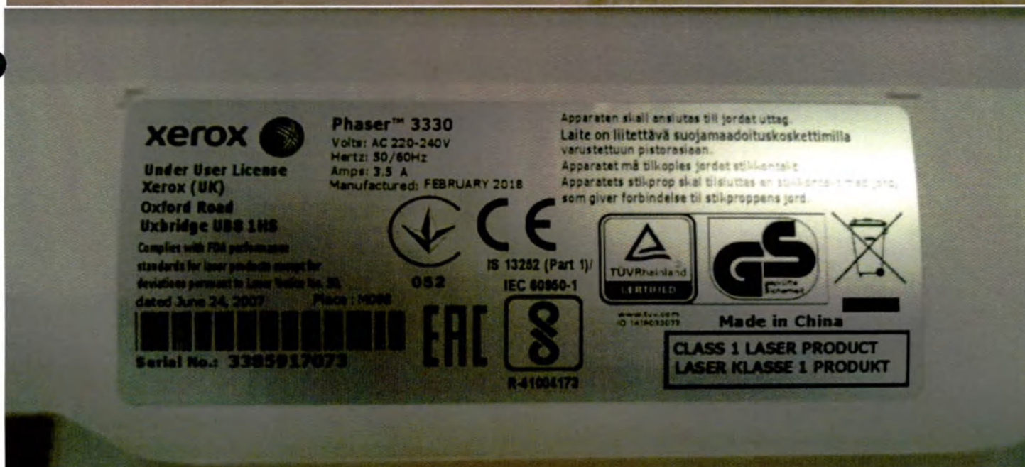
Фотография 58 – Принтер лазерный серии Phaser, производства Xerox Limited. Внешний вид и маркировка
