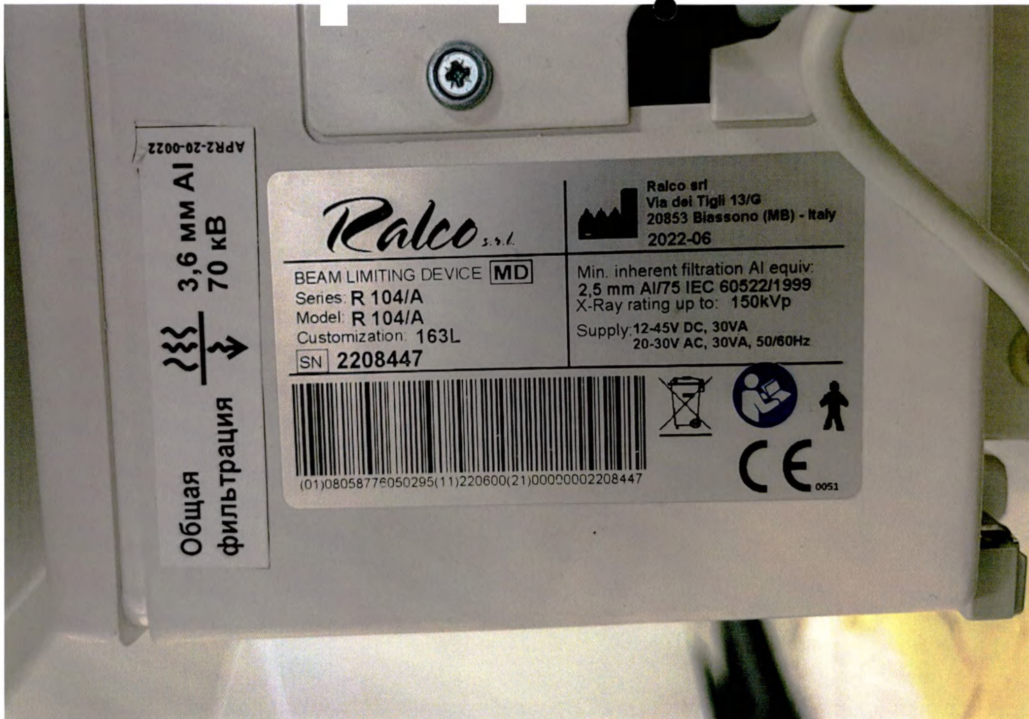
Фотография 18 – Коллиматор (диафрагма) серии R 104/A Ralco srl. Маркировка
