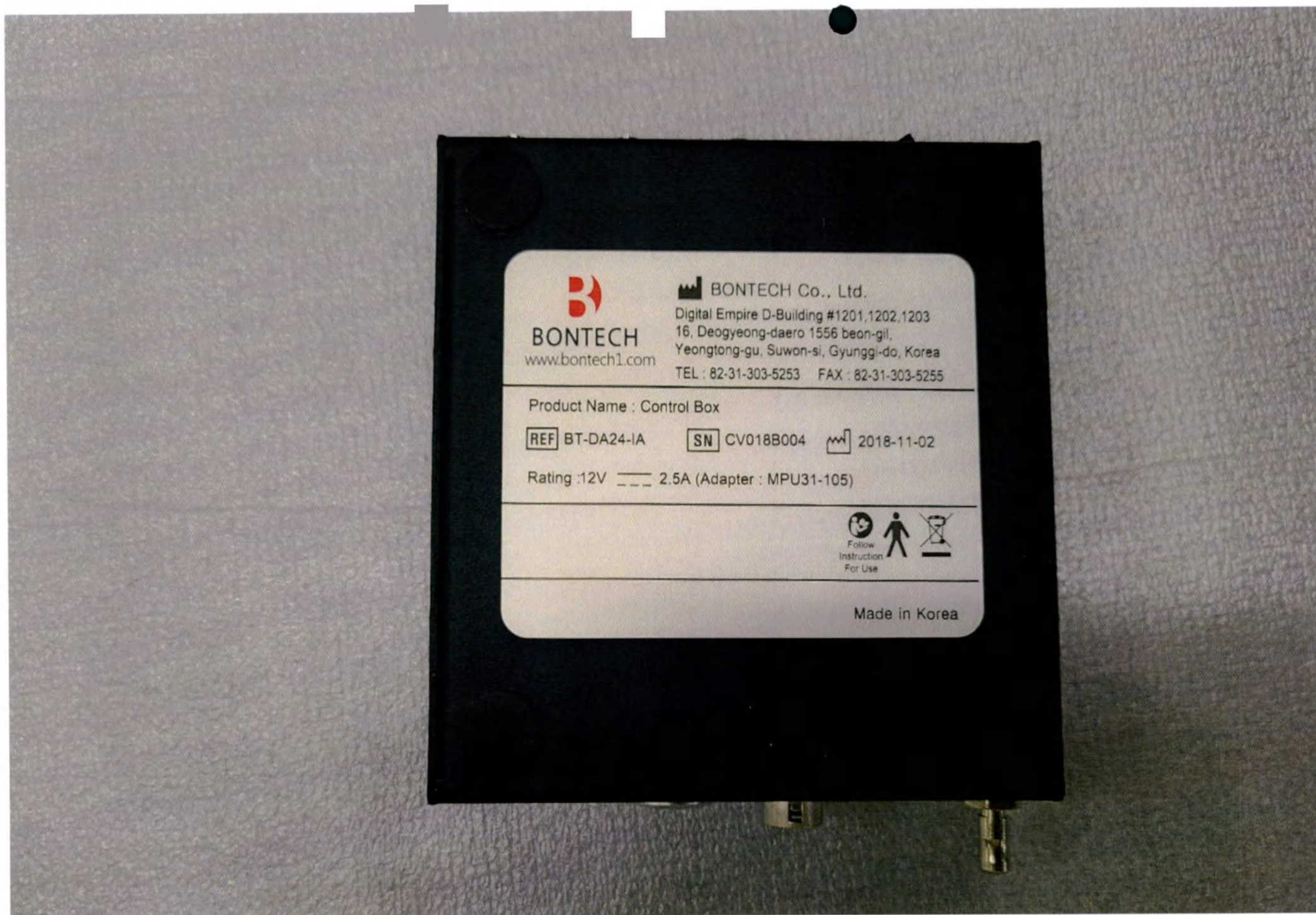
Фотография 54 – Блок управления детектора BONTECH Co., Ltd, Республика Корея и его маркировка
