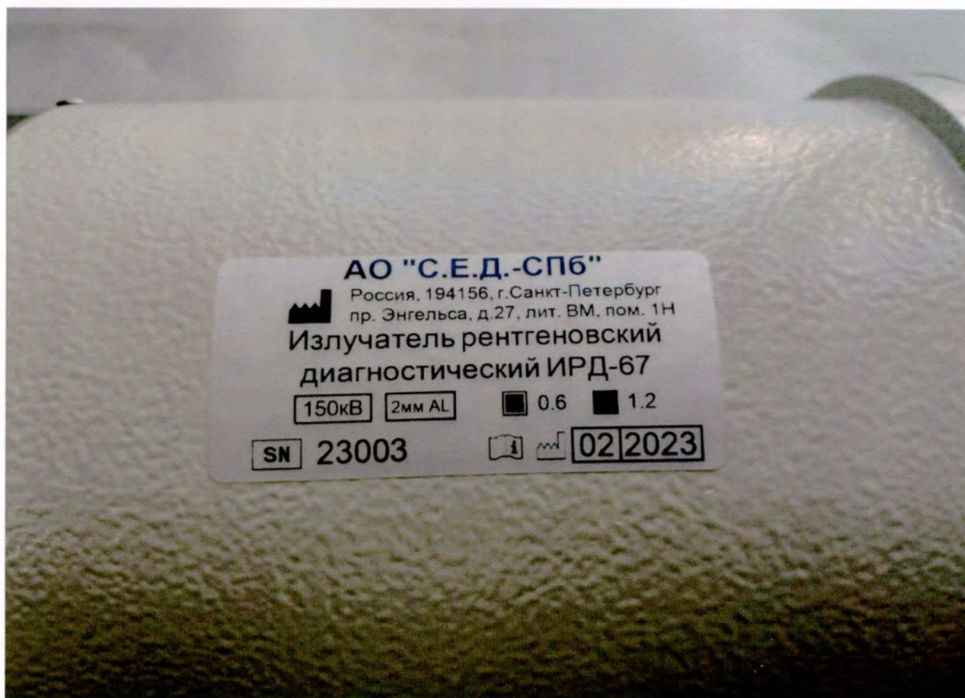
Фотография 14 – Маркировка излучателя рентгеновского серии ИРД, АО «С.Е.Д.-СПб»
