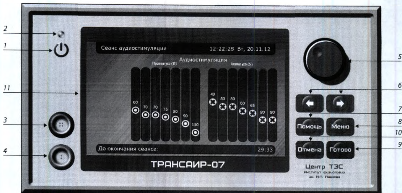
Рис.15. Вид дисплея при проведении сеанса АС (снятая аудиограмма с заданным превышением).
