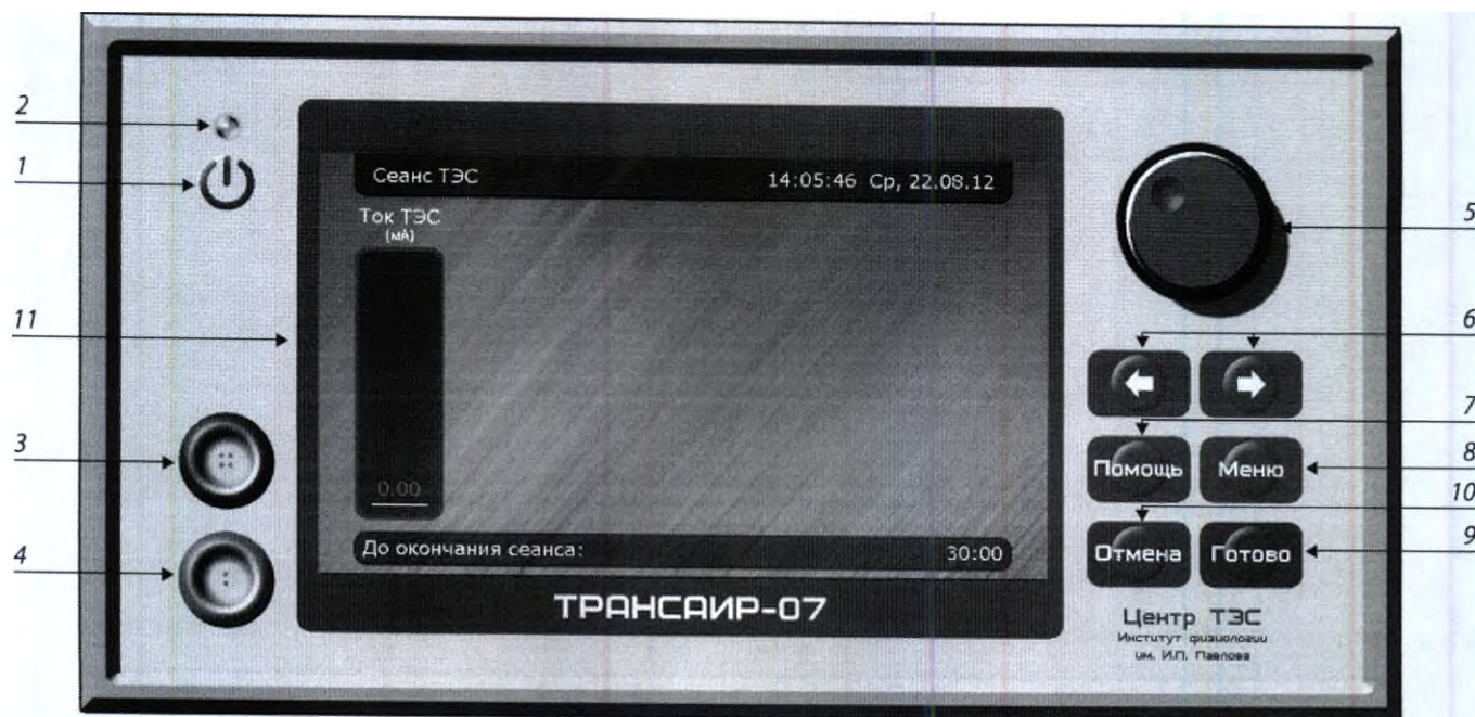
Рис. 11. Вид дисплея при проведении сеанса ТЭС-терапии.
