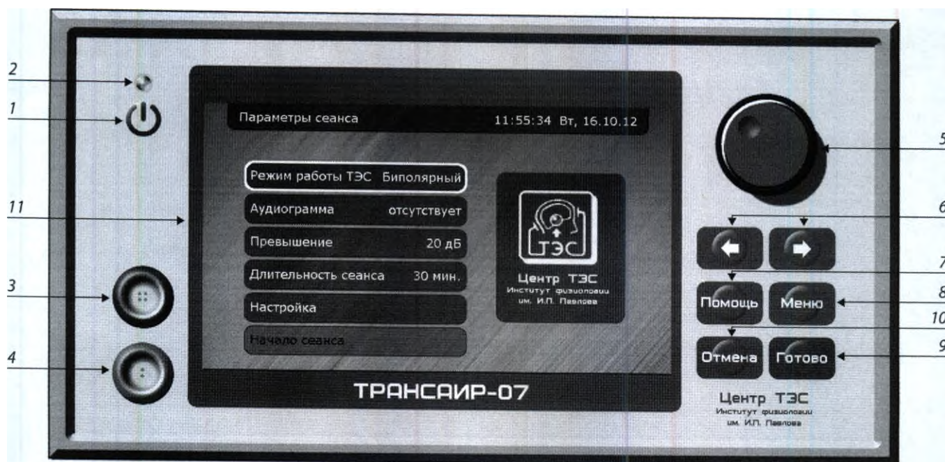
Рис. 3. Вид дисплея после успешной проверки работоспособности аппарата.
