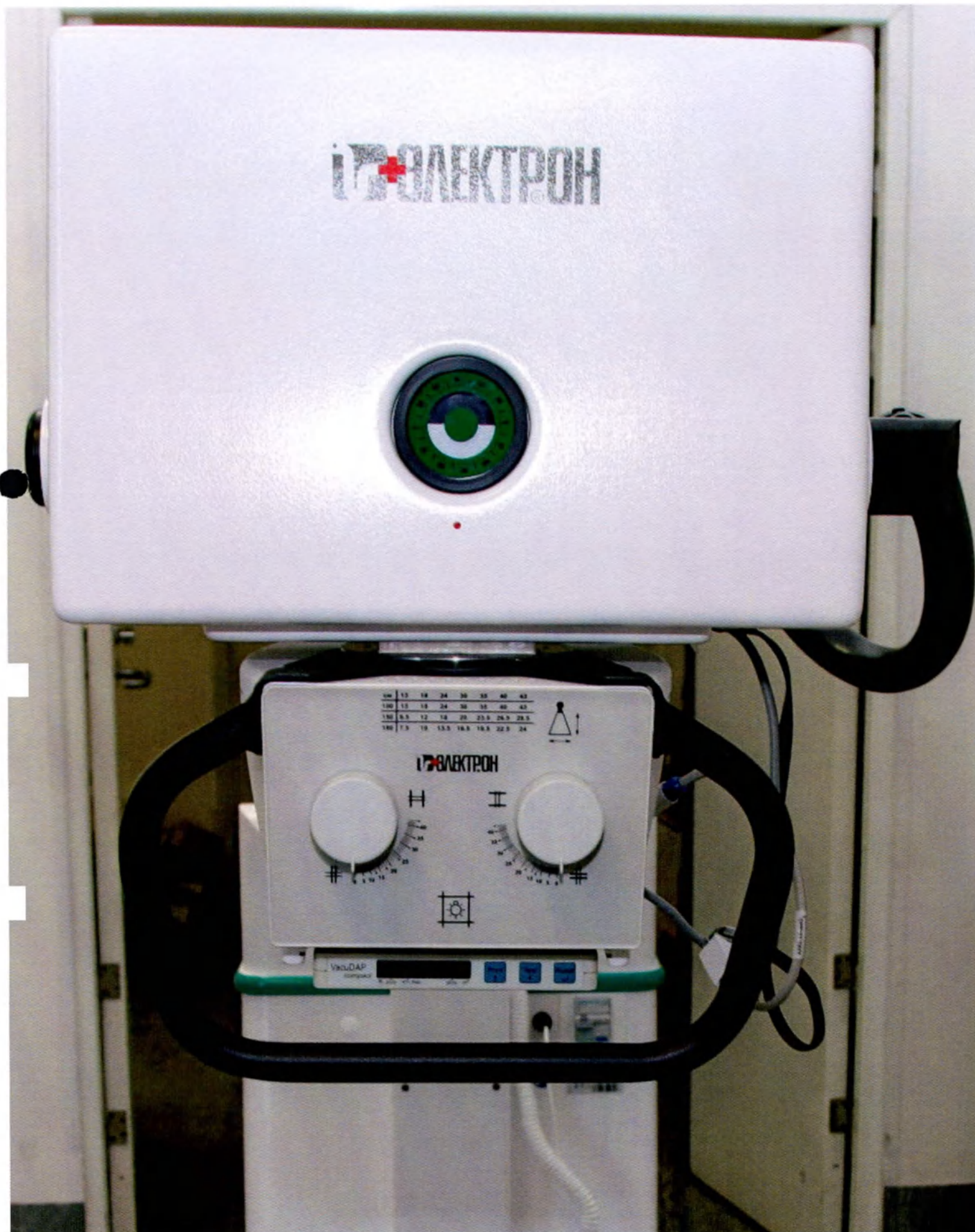
Фотография 9 – Моноблок рентгеновский серии BMX, BMI Biomedical International srl., Италия (с установленным под моноблоком коллиматором Ralco и дозиметром VacuDAP VacuTec)
