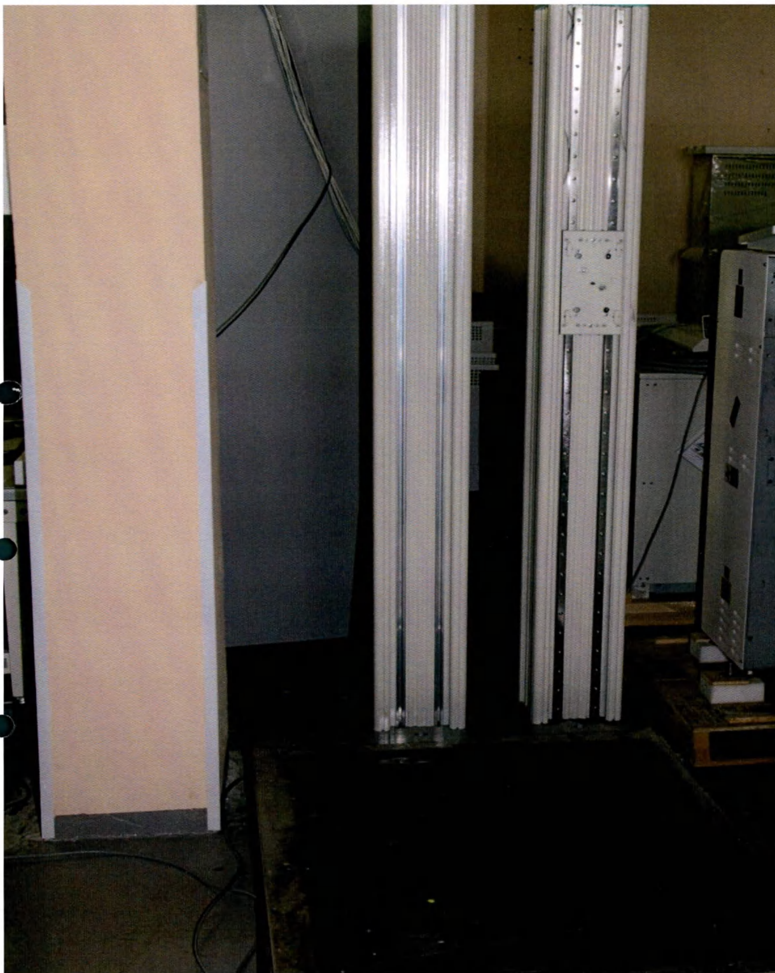
Фотография 32 – Колонна с направляющими серии SUR-20 включающей профиль 201 030 9300, FOSHAN ZP ALUMINUM CO., LTD, Китай или ZP GROUP CO., LIMITED, Китай
