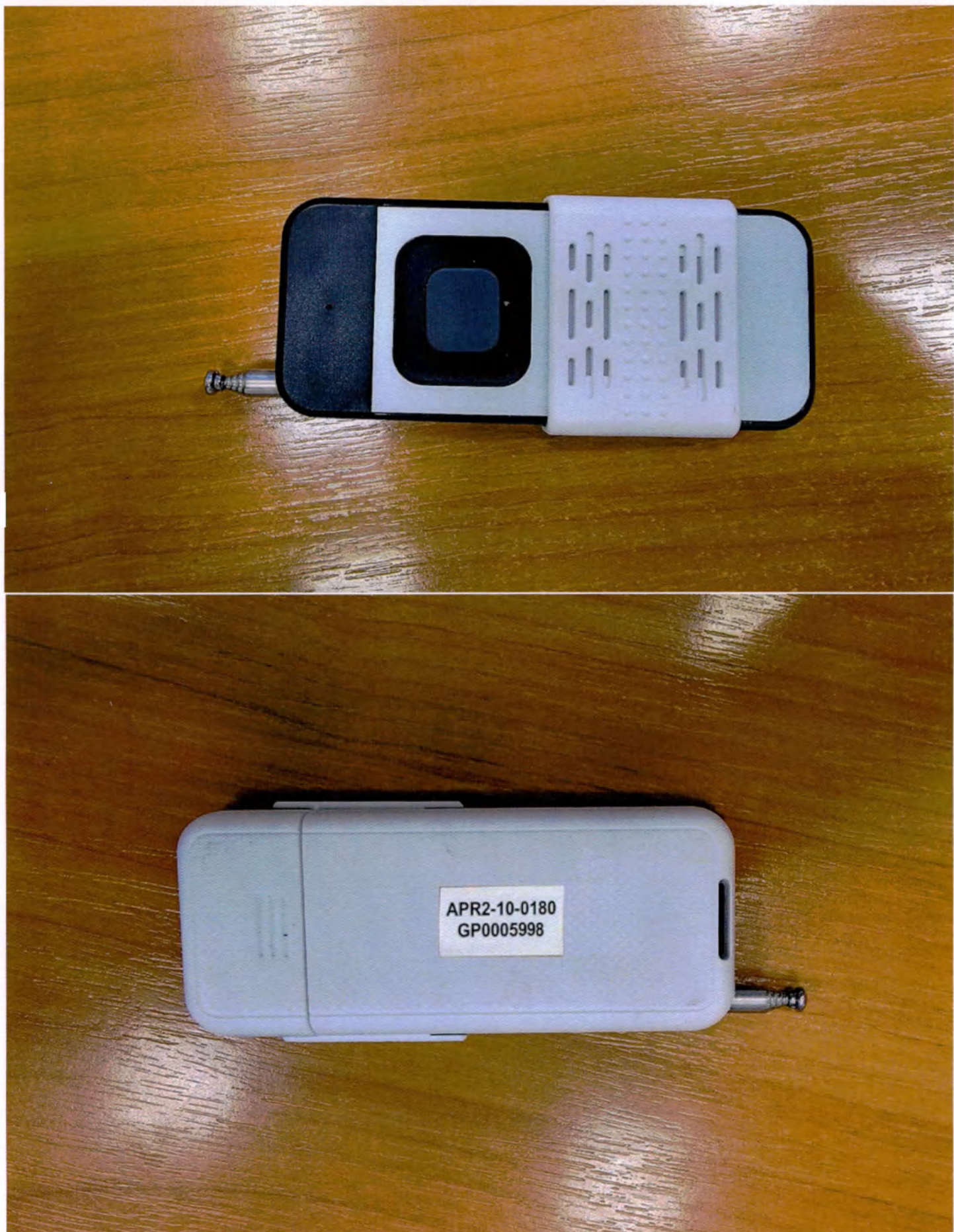
Фотография 26.1 – Двухкносовая кнопка управления экспозицией APR2-10-0180 (вариант внешнего вида) и маркировка
