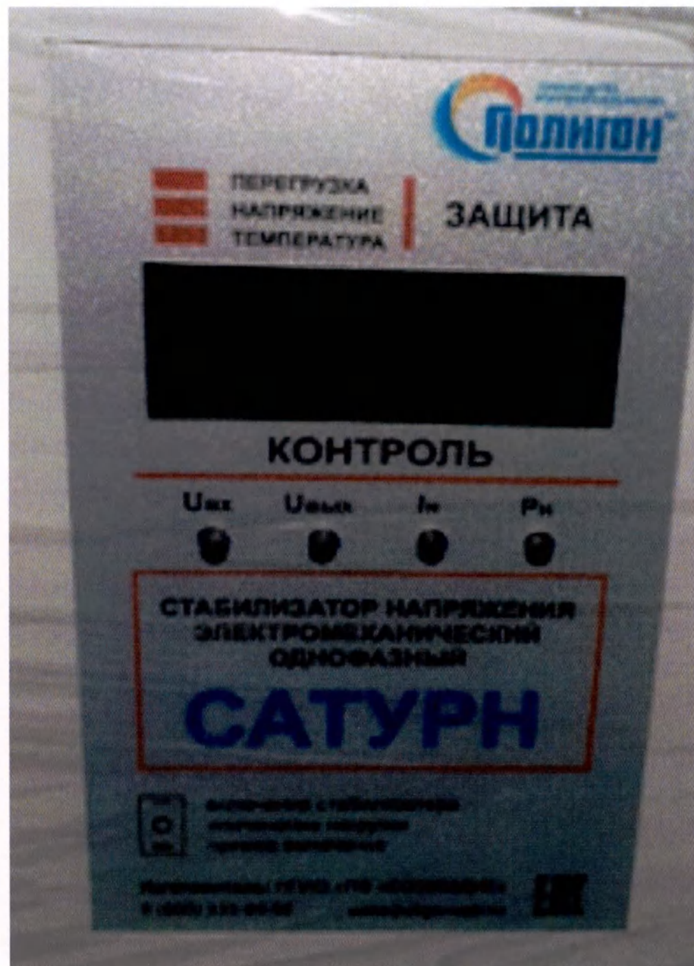
Фотография 91 – Стабилизатор серии СНЭ (вариант внешнего вида) в составе спецификации XRPS-10, АО «НИПК «Электрон»
