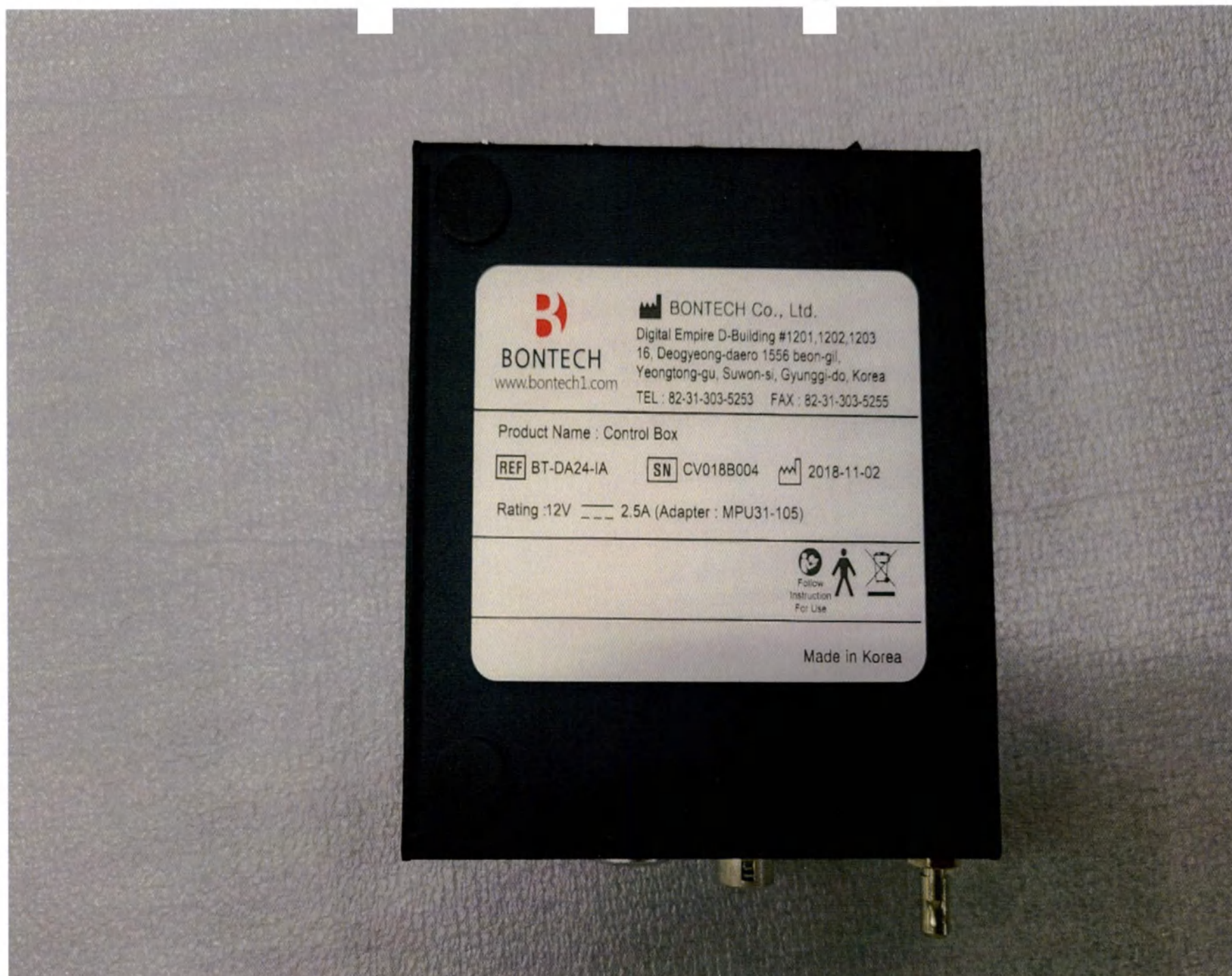
Фотография 56 – Блок управления детектора BONTECH Co., Ltd, Республика Корея и его маркировка
