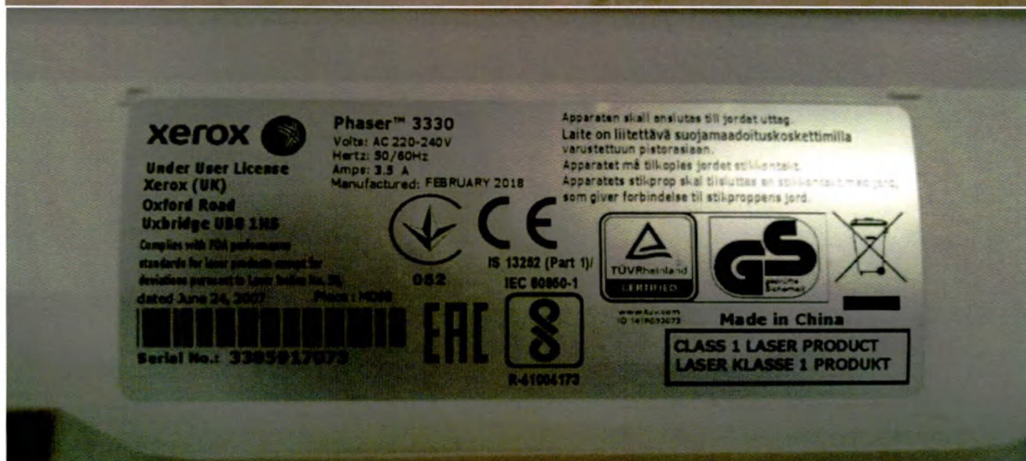
Фотография 60 – Принтер лазерный серии Phaser, производства Xerox Limited. Внешний вид и маркировка
