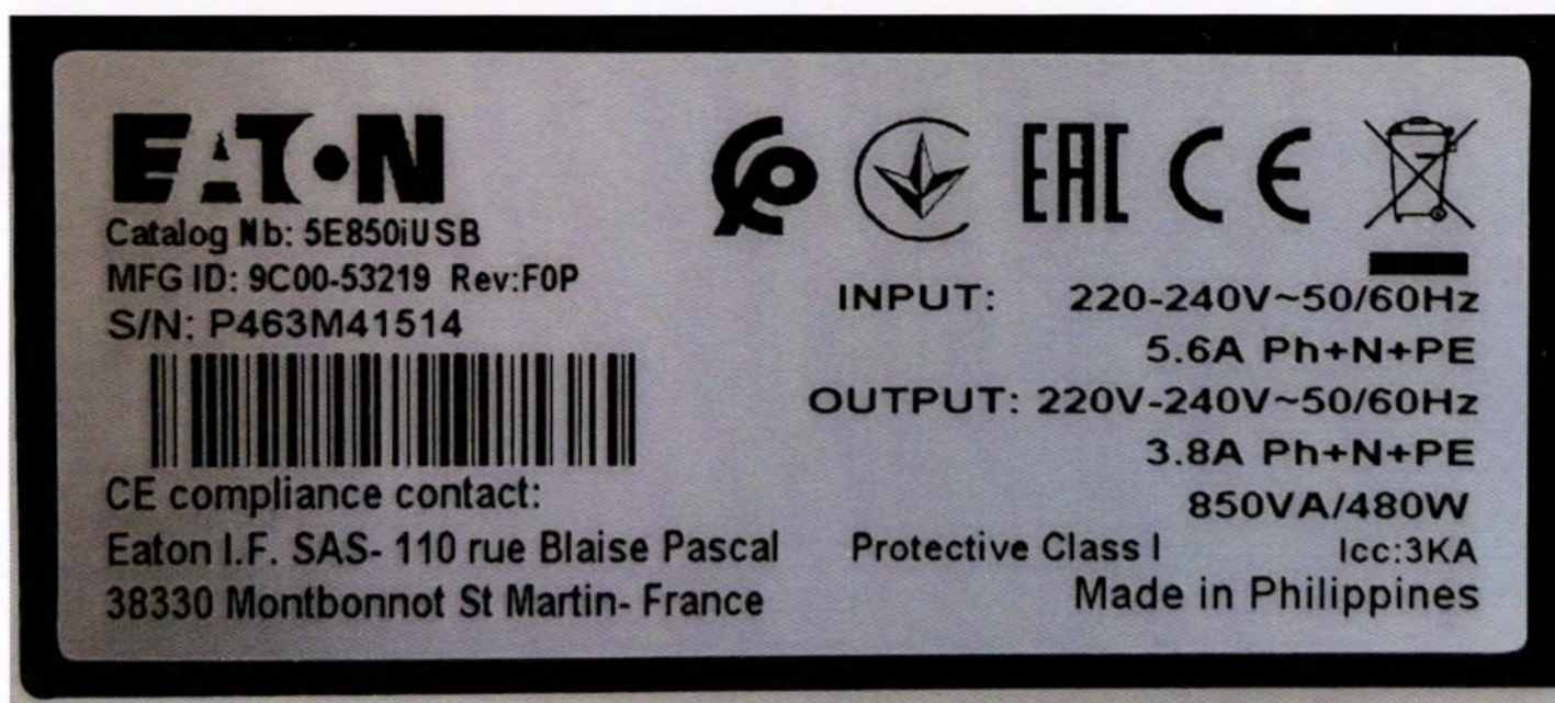
Фотография 88 – Источник бесперебойного питания Eaton. Маркировка
