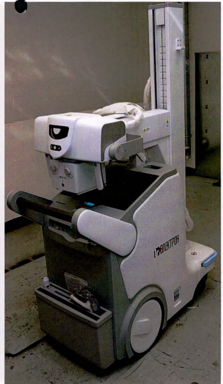
Фотография 3.1 – Вариант внешнего вида АПР-ОКО в составе с Блоком передвижным рентгеновским серии MobileCooper, Shenzhen Browiner Tech Co, включающим Систему позиционирования рентгеновскую MC Shenzhen Browiner Tech Co., Ltd, Китай в рабочем и транспортном положении
