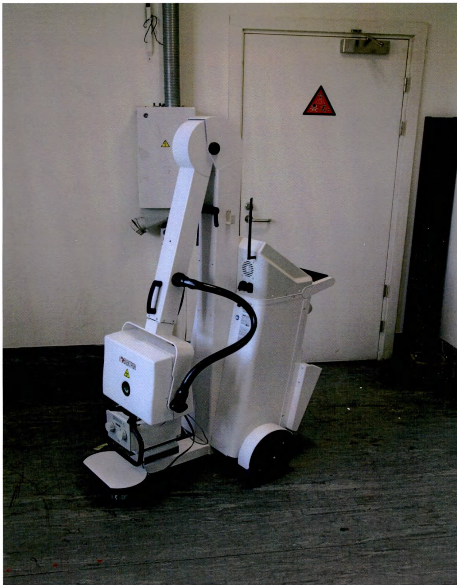
Фотография 1 – Аппарат палатный рентгенографический АПР, исполнение АПР-ОКО (вариант внешнего вида) по спецификации включающей Блок передвижной рентгеновский с аппаратом рентгеновским передвижным с высокочастотным генератором серии Mobildrive BMI Biomedical International srl., Италия/ПУ № ФСЗ 2012/12129
