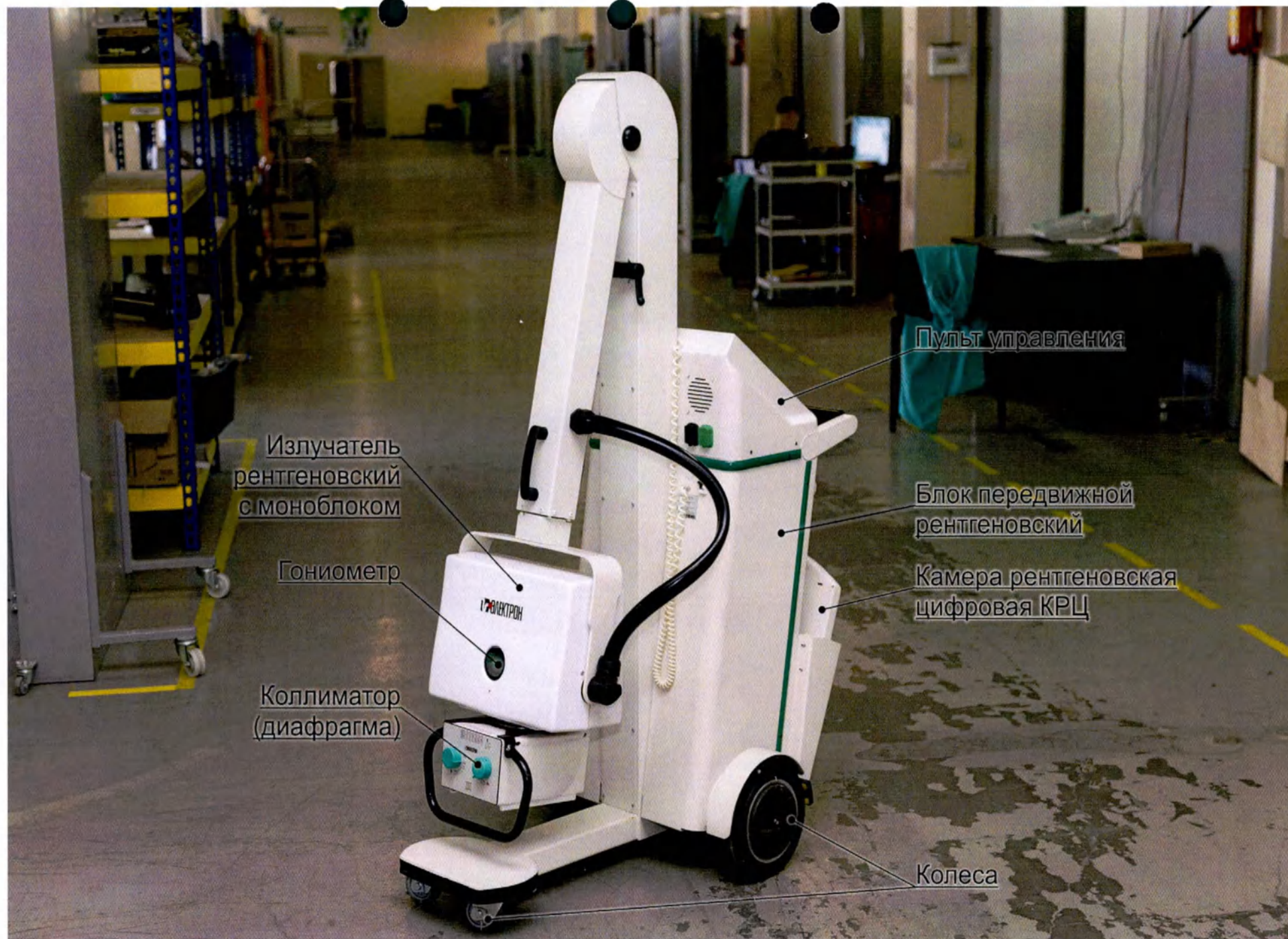
Фотография 2 – Аппарат палатный рентгенографический АПР, исполнение АПР-ОКО (вариант внешнего вида с указанием основных узлов) по спецификации с Блоком передвижным рентгеновским серии Jolly, BMI Biomedical International srl., Италия
