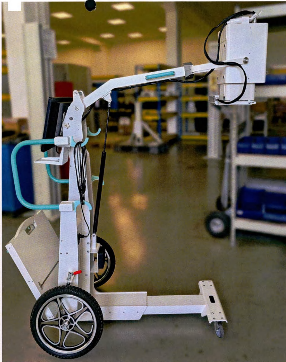
Фотография 3.2 – Вариант внешнего вида АПР-ОКО, в составе с Блоком передвижным рентгеновским APR2-00 по спецификации в рабочем и транспортном положении
