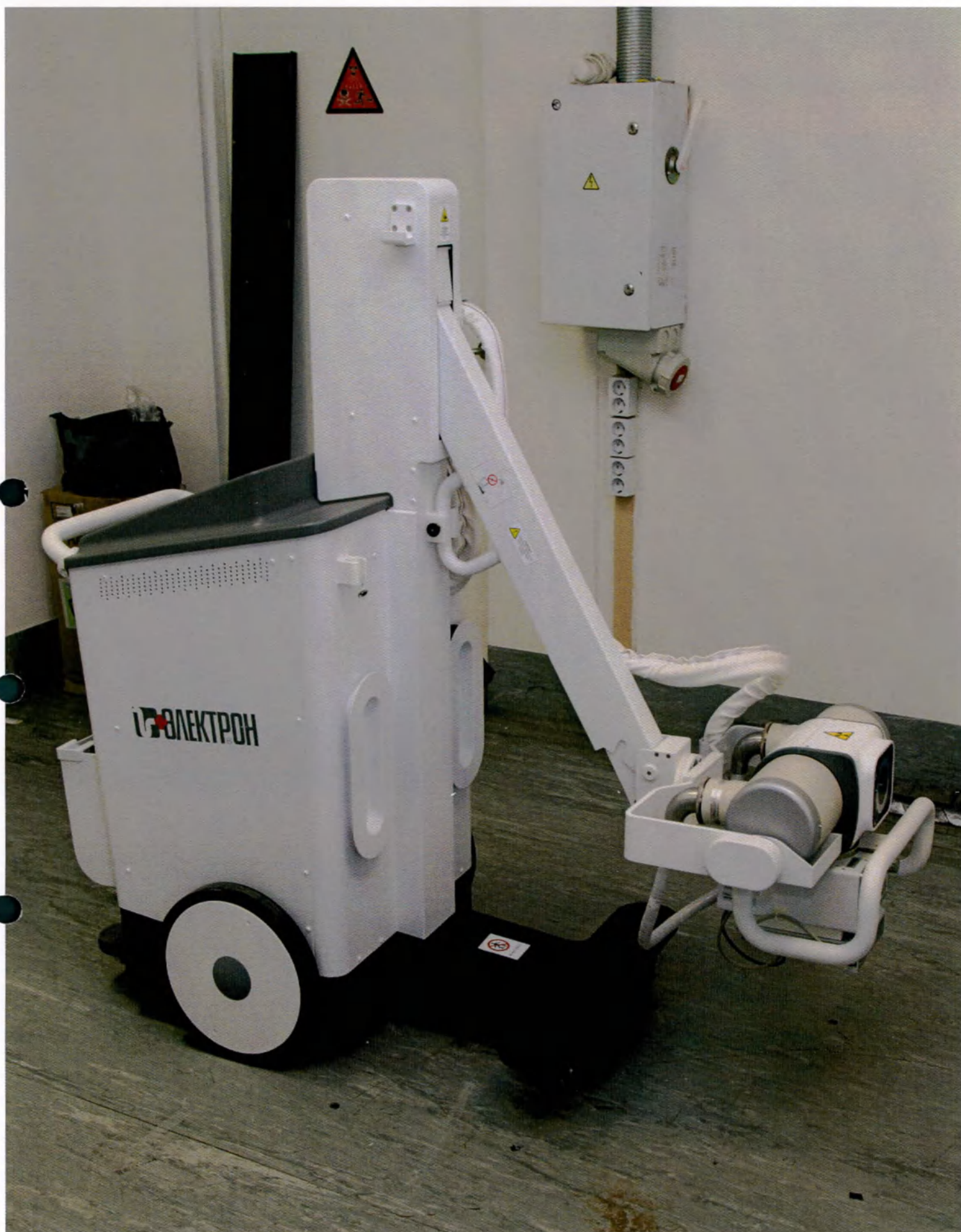
Фотография 3 – Аппарат палатный рентгенографический АПР, исполнение АПР-ОКО (вариант внешнего вида) с Блоком передвижным рентгеновским серии MobileCooper, Shenzen Browiner Tech Co включающим Систему позиционирования рентгеновскую MC Shenzen Browiner Tech Co., Ltd, Китай
