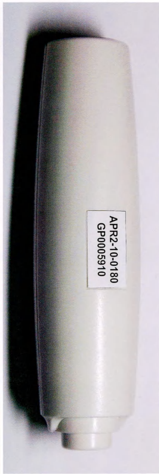
Фотография 26 – Двухходовая кнопка управления экспозицией APR2-10-0180 (вариант внешнего вида) и маркировка
