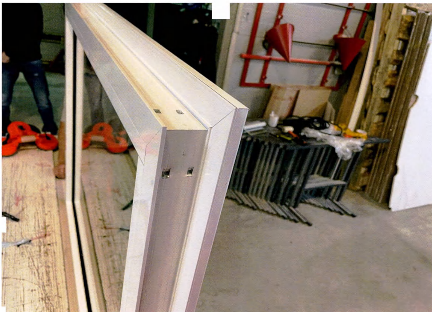
Фотография 43 – Окно рентгенозащитное серии Roesys XPW, Roesys GmbH, Германия
