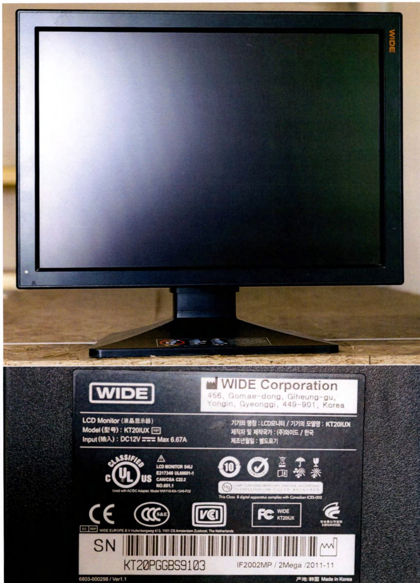
Фотография 73 – Монитор серии IF (вариант внешнего вида), WIDE Corporation, Республика Корея
