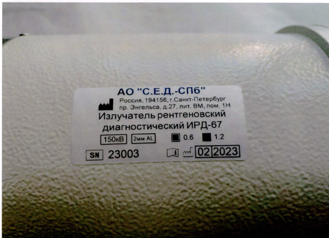
Фотография 15 – Маркировка излучателя рентгеновского серии ИРД, АО «С.Е.Д.-СПб»
