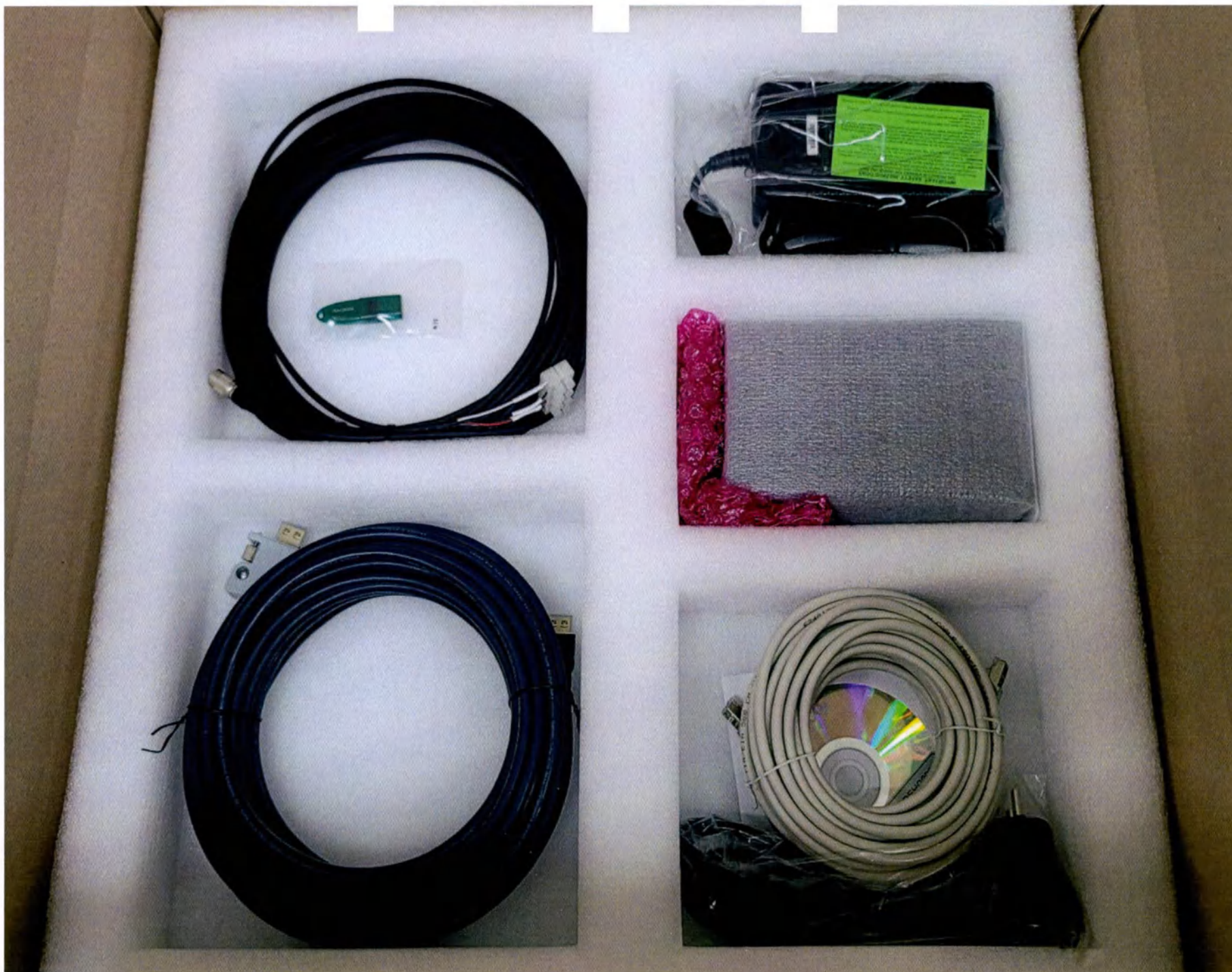
Фотография 52 – Комплект поставки Цифрового радиографического детектора серии DRA ASTEL Inc, Республика Корея
