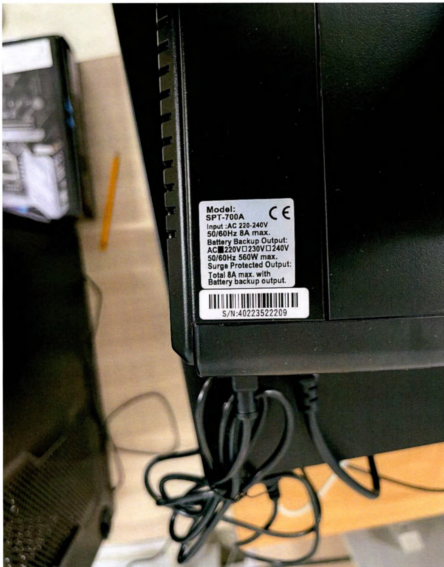
Фотография 90 – Источник бесперебойного питания серии SPT, POWERCOM CO., Маркировка
