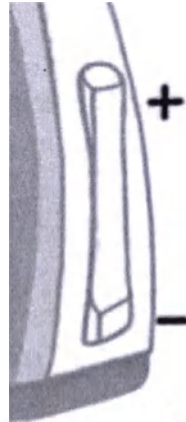
Рис. 6. Регулировка уровня звука цифровым регулятором
