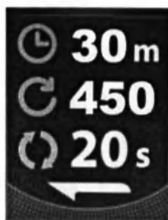
Рисунок 7 – Экран манипулы в режиме реверсного вращения
