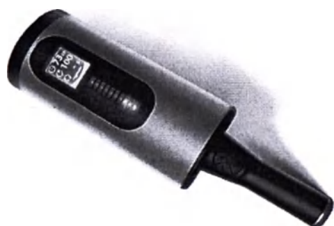
Рисунок 6 – Вспомогательный дисплей манипулы в режиме работы
