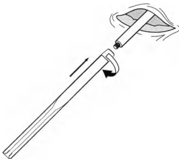
Рис. 4. Повне пригвинчування системи доставки до стрижня для тунелювання.
