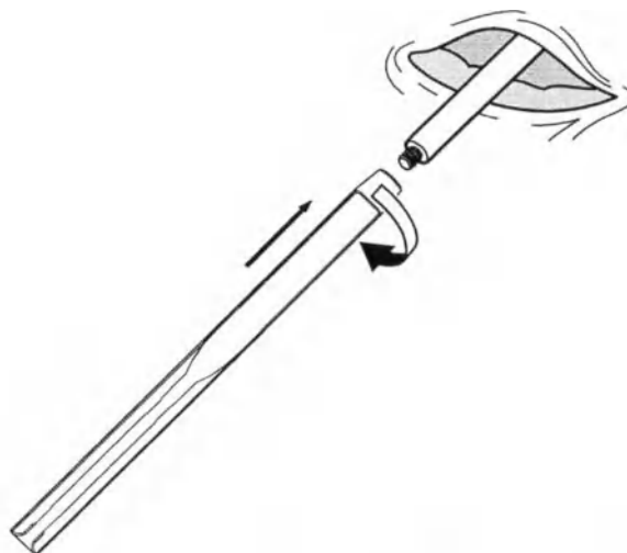
Figura 4. Enroscamiento completo del portador en la varilla de tunelización.
