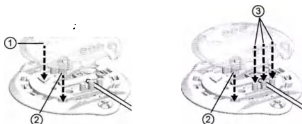
Рис. 9. Совмещение крышки для ее защелкивания на основании
