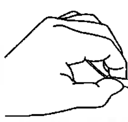
Figura 3. Strângerea clemă crocodil pentru a acționa cablul unipolar.
