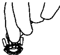
Figura 4. Extracción de la herramienta de centrado.
