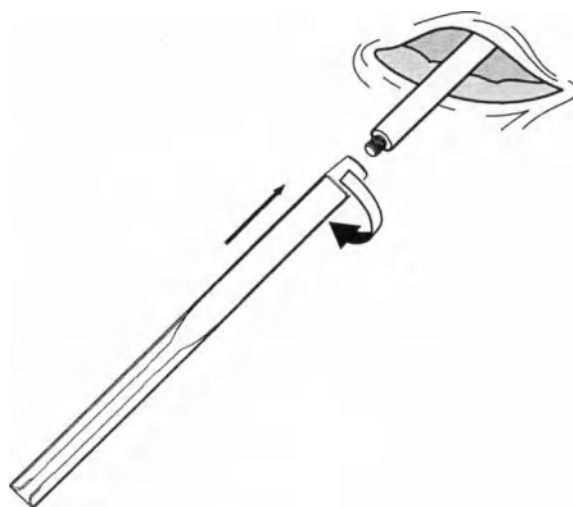
Рис. 4. Прикручивание системы доставки к стержню для туннелирования до упора.
