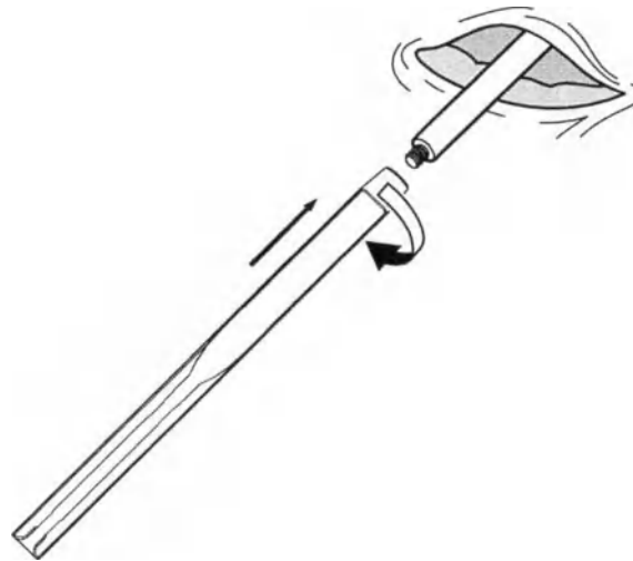
Gambar 4. Memasukkan pembawa dengan mengulir sepenuhnya ke dalam tangkai tunneling.
