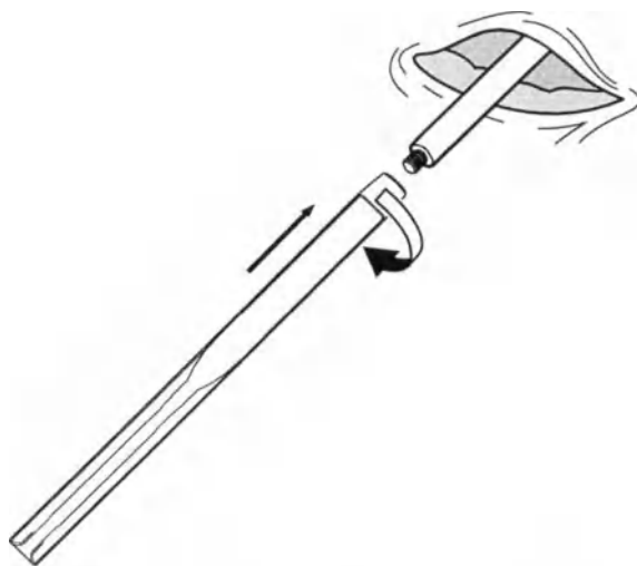
Slika 4. Zavijanje nosača na štap za kanalisanje do kraja.
