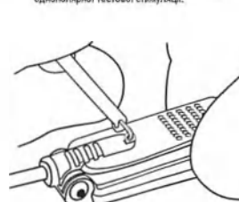
Рис. 2. Приєднання мініаторного гачка до кабелю конектора кабелю для тестування електродів.
