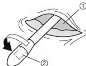
Figura 3. Extracción de la punta de la varilla de tunelización.
