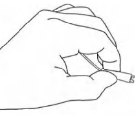
Рис. 3. Сдвигание задней части зажима "крокодиль" для разблокировки монополярного кабеля
