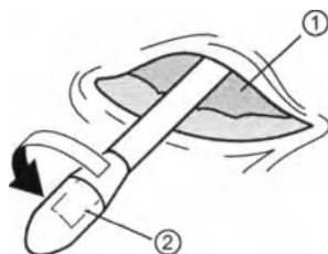
Hình 3. Tháo đầu mũi ra khỏi thanh tạo đường dẫn.
