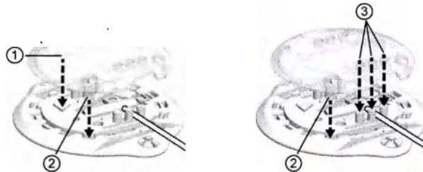
Gambar 9. Menyejajarkan penutup untuk memasang ke dalam dudukan.
