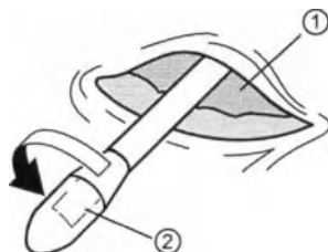
Slika 3. Skidanje vrha sa štapa za kanalisanje.
