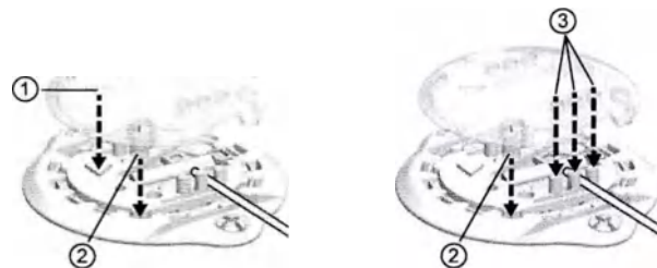
Hình 9. Căn chỉnh nắp để gắn nắp khớp vào đế.
