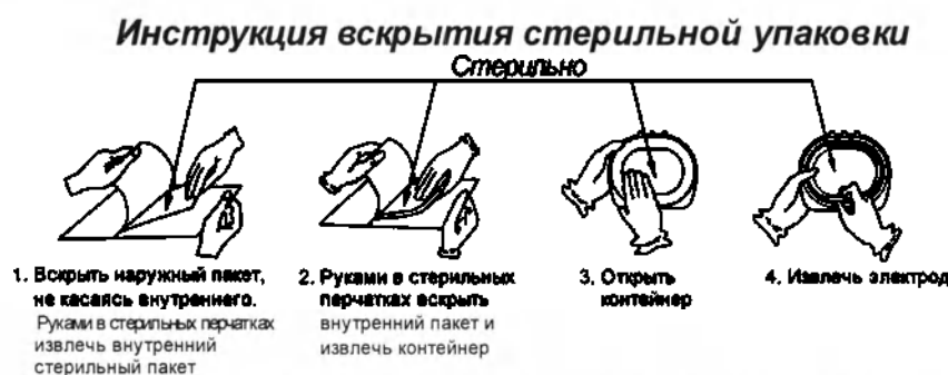
Рисунок 2 – Порядок вскрытия стерильной упаковки
