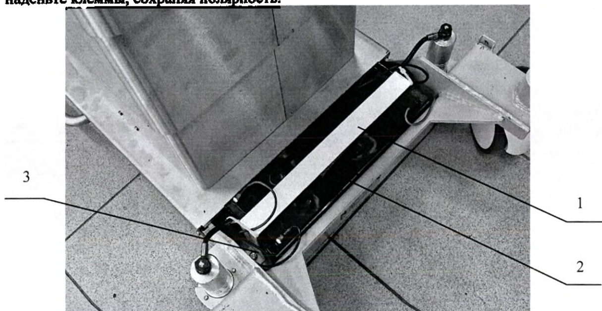
Рисунок 19. Замена аккумуляторных батарей.
