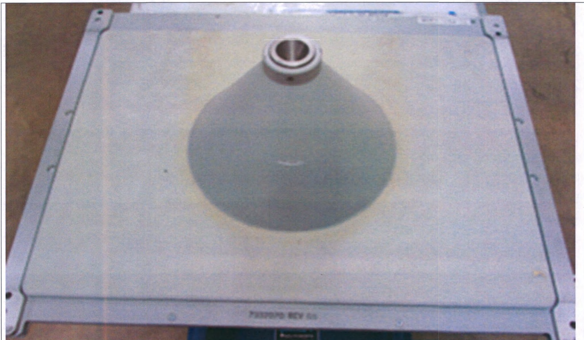
19. Коллиматоры точечные («пинхол») с точечными насадками, 4 мм
