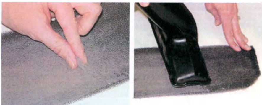
Рис. 15-4. Чистка воздушного фильтра
