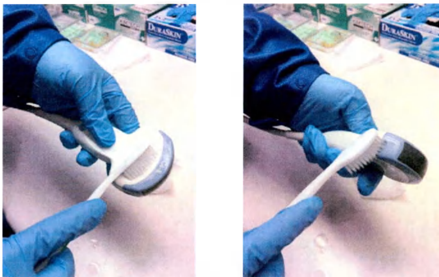
Рис. 13-7. Чистка датчика щеткой
