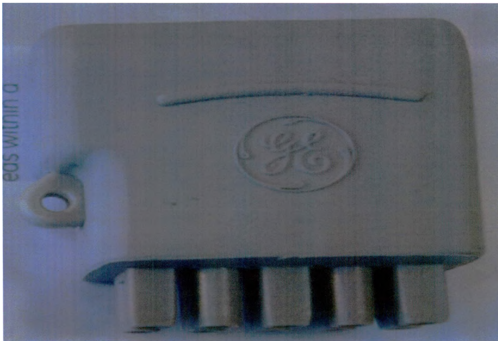
Адаптер для подключения модуля, обеспечивающего регистрацию физиологических сигналов к набору детских ЭКГ-кабелей
