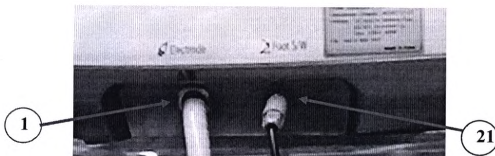
Рисунок 11 – Разъемы на блоке управления (1 – подключение аппликатора; 2 – подключение ножного переключателя)
