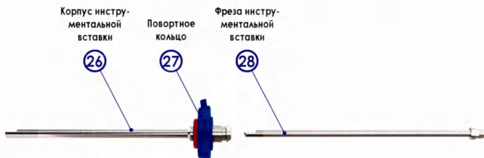
Рисунок 4. Риноскопическая инструментальная вставка. В разобранном виде
