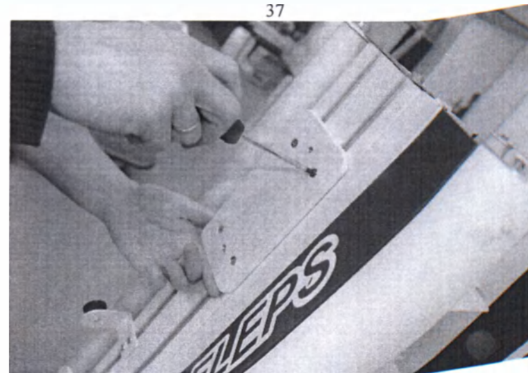
Рисунок 20. Установка плиты кронштейна дополнительного видеомонитора
