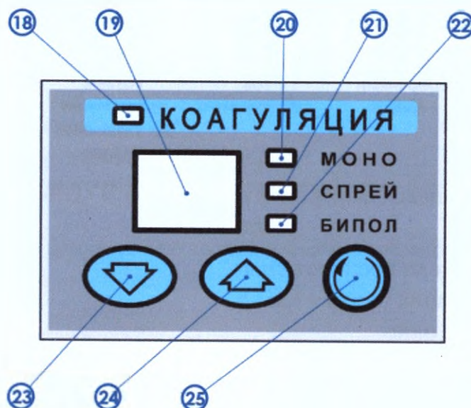
Рисунок 3. Органы управления режимами монополярной и биполярной коагуляции (фрагмент передней панели)
