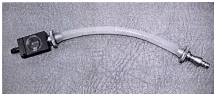
Рисунок 7. Нагнетательная трубка в сборе с датчиком давления и штуцером.
