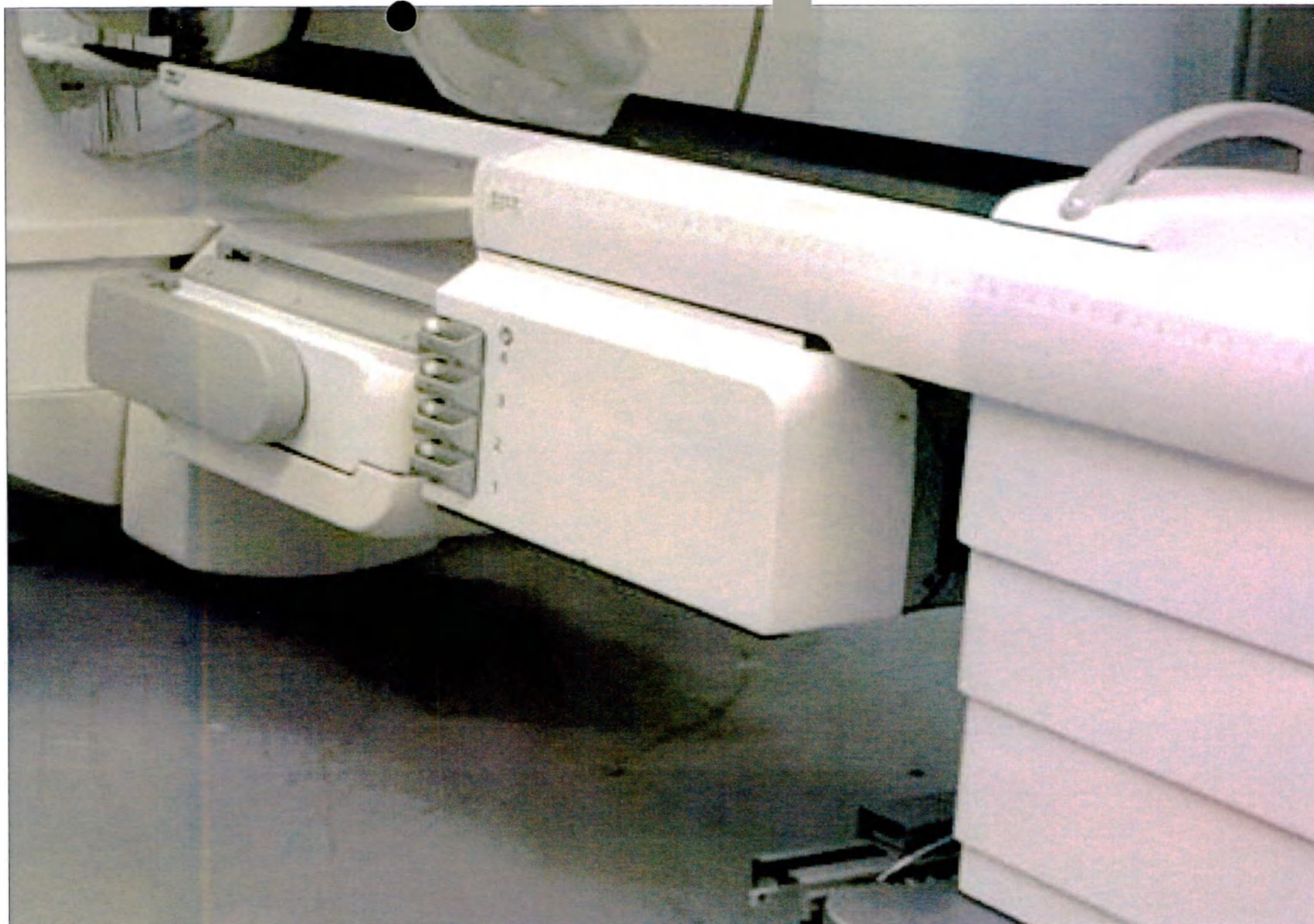
36. Система для автоматической смены коллиматоров: модуль для смены коллиматоров, встроенный; режим программный для автоматической смены коллиматоров
