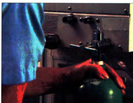
Рисунок 8-19 Соединение баллона с переходником
