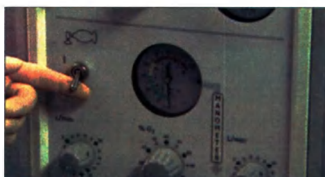
Рисунок 8-49 Переключатель подачи медицинского газа в положении «Выкл.»
