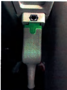
Рис. 6. Кабель ЭКГ подключен к обогревателю
