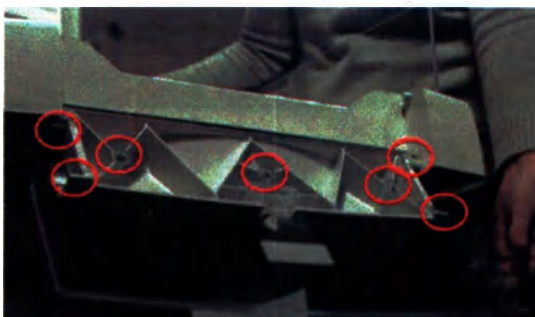
Рисунок 8-3 Защелки, отверстия под винты и петли
