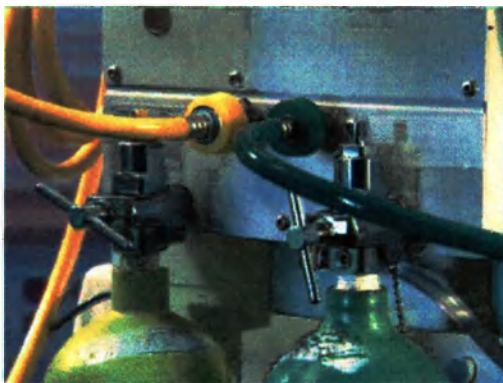
Рисунок 8-26 Разъемы для подачи газа под низким давлением
