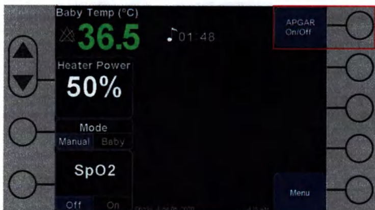
Рисунок 10-15 Включение/выключение функции оценки по шкале Апгар
