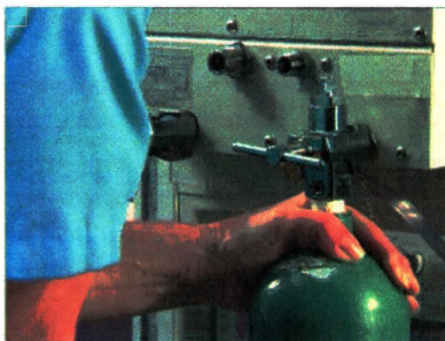
Рисунок 8-19 Соединение баллона с переходником
