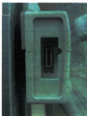
Рисунок 10-44 Разъем для датчика Masimo SET® 2
