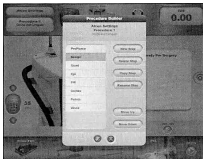
Рисунок 2-58 Выбор шага в диалоге построения процедуры Выбор шага в диалоге построения процедуры позволит пользователю производить «Удаление (Delete)», «Копирование (Copy)», «Переименование (Rename)» или «Перемещение (Move)» шага.
