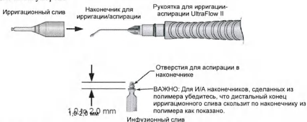
Рисунок 3-6 Подготовка ирригационного слива/наконечника рукоятки ирригации-аспирации
