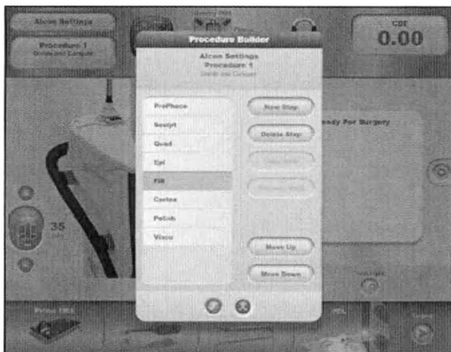
Рисунок 2-57 Диалог построения процедуры с добавленным шагом «Заполнение (Fill)» В данном случае шаг «Заполнение (Fill)» был выбран из правой колонки диалога шагов (смотрите предшествующий рисунок). Шаг «Заполнение (Fill)» появляется внизу существующих шагов, затем была нажата клавиша «Перемещение вверх (Move Up)», чтобы переместить шаг «Заполнение (Fill)» после шага «Надъядерный слой (Epi)». Больше шагов может добавляться, удаляться или перемещаться до сохранения действия с помощью нажатия зеленой кнопки (✓).
