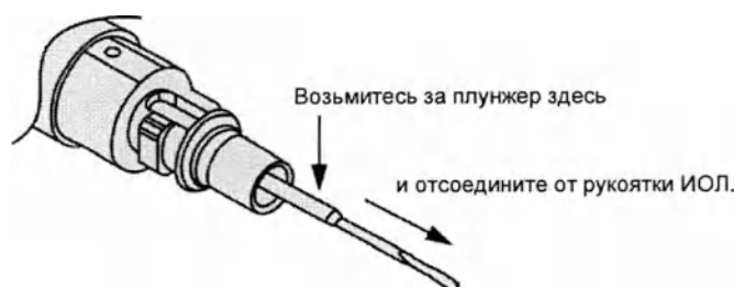
Рисунок 3-7 Удаление плунжера из рукоятки-инжектора ИОЛ Intrepid AutoSert .
