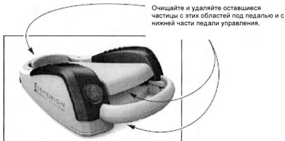
Рисунок 4-1 Очистка педали управления. очищайте от оставшихся частиц поверхность педали, а также с ее обратной стороны, они могут нарушать функционирование педали.
