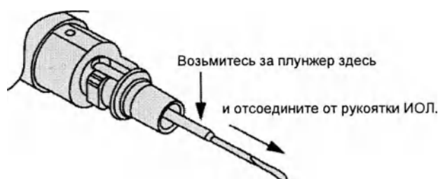
Рисунок 3-7 Удаление плунжера из рукоятки-инжектора ИОЛ Intrepid AutoSert.
