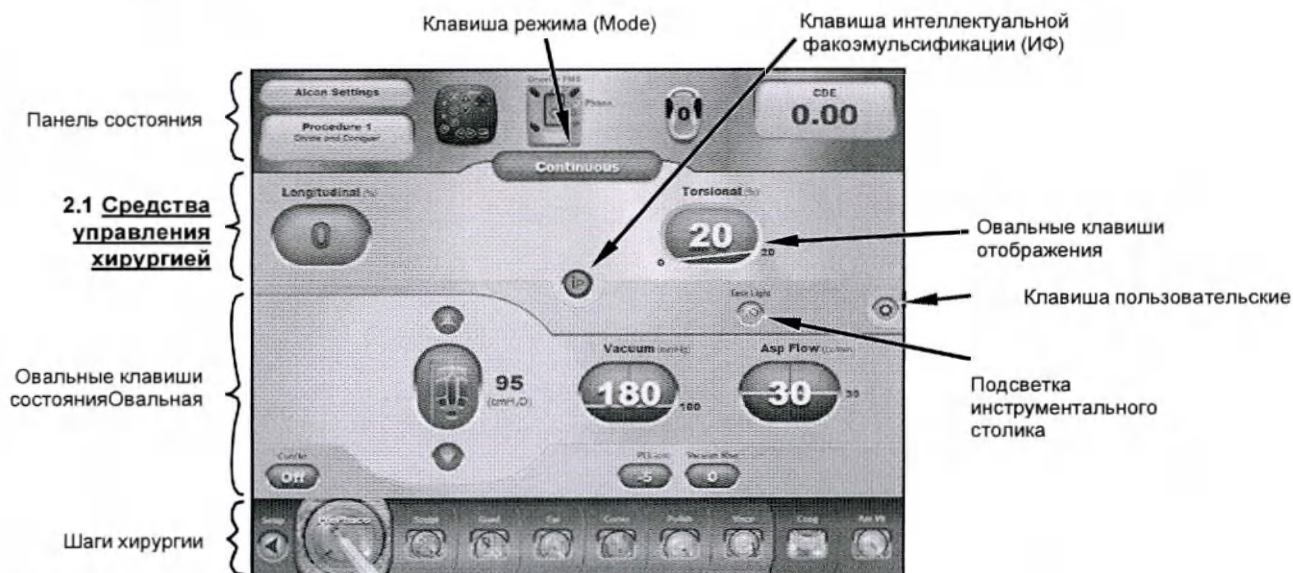
Рисунок 2-65 Окно управления хирургией с элементами управления Верхняя половина окна управления хирургией используется для наблюдения за уровнями ультразвука во время текущей хирургии и для изменения настроек ультразвука с помощью нажатия овальных клавиш отображения и клавиш для представления диалогов управления.
