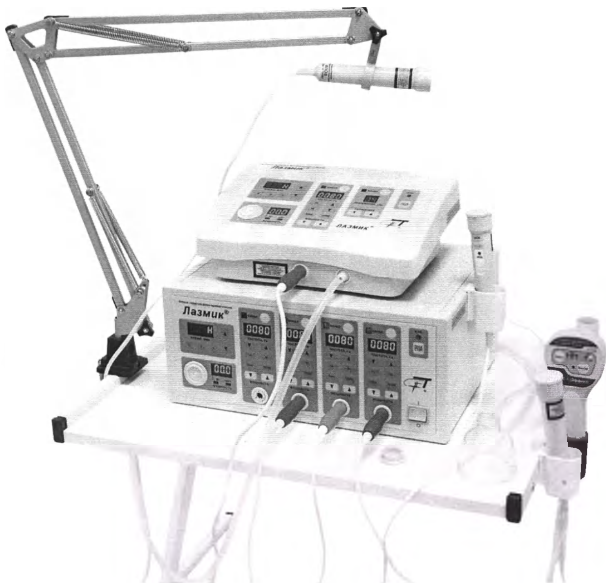
Стр. 12. Стойка аппаратная универсальная ЛАЗМИК-СФ с держателем излучающих головок
