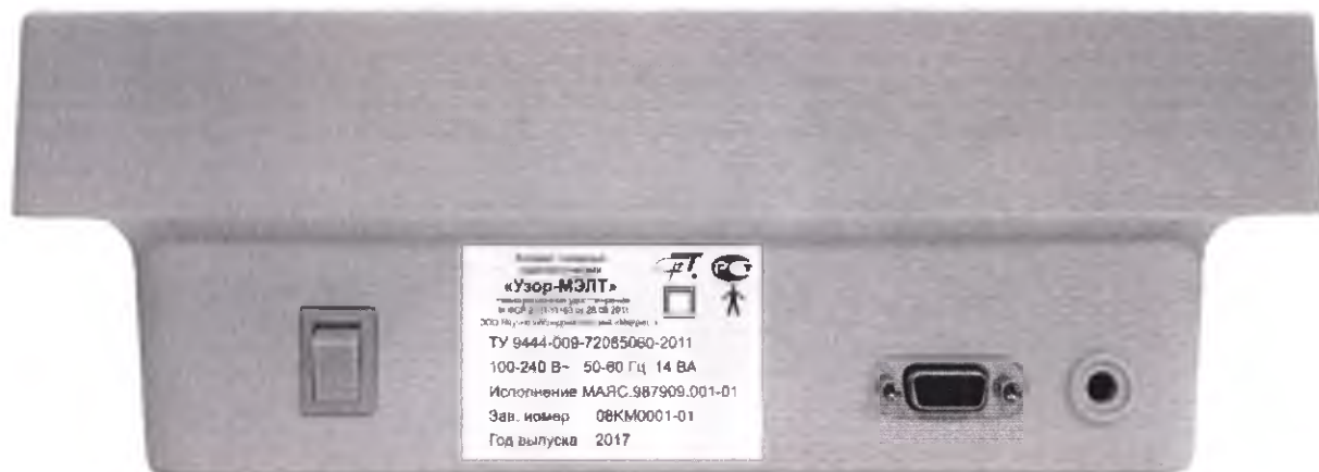
Рис. 3.1. Внешний вид аппарата со стороны задней панели, вариант исполнения МАЯС.987909.001-01 (2 лазерных канала), слева направо: сетевой выключатель, этикетка (шильдик) с указанием заводского номера аппарата и даты производства, разъём для подключения внешнего управления, разъём для подключения специального блока питания (адаптера).
