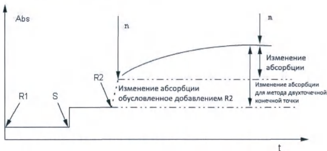
Рисунок 7.1.1 Реакционная кривая иммунного метода
