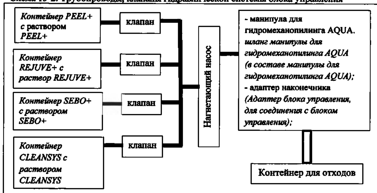
Схема 13-2. Трубопроводы, клапаны гидравлической системы блока управления
