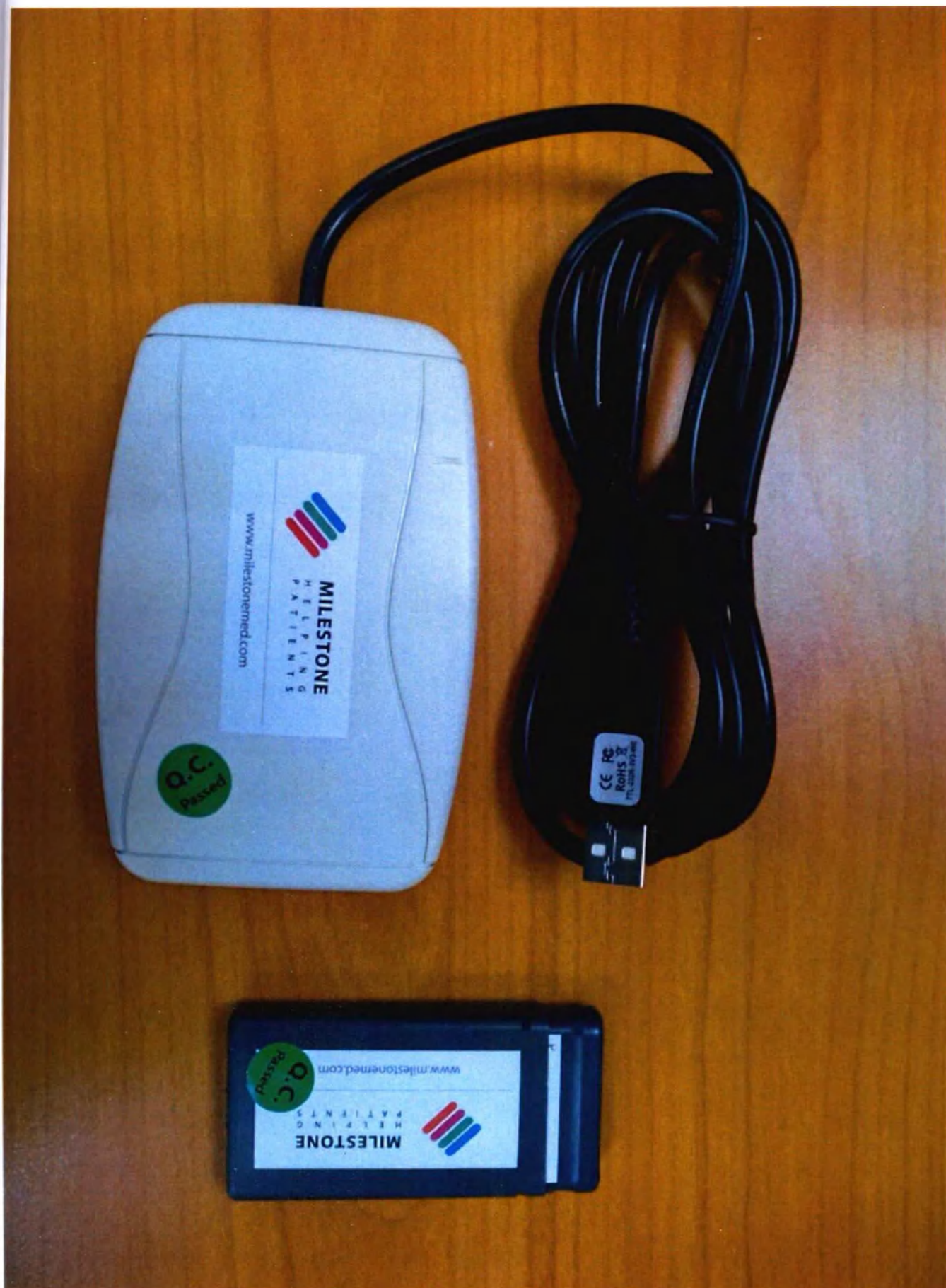
Фото 16. Устройство для считывания и контроля температуры (Temperature monitoring system)
