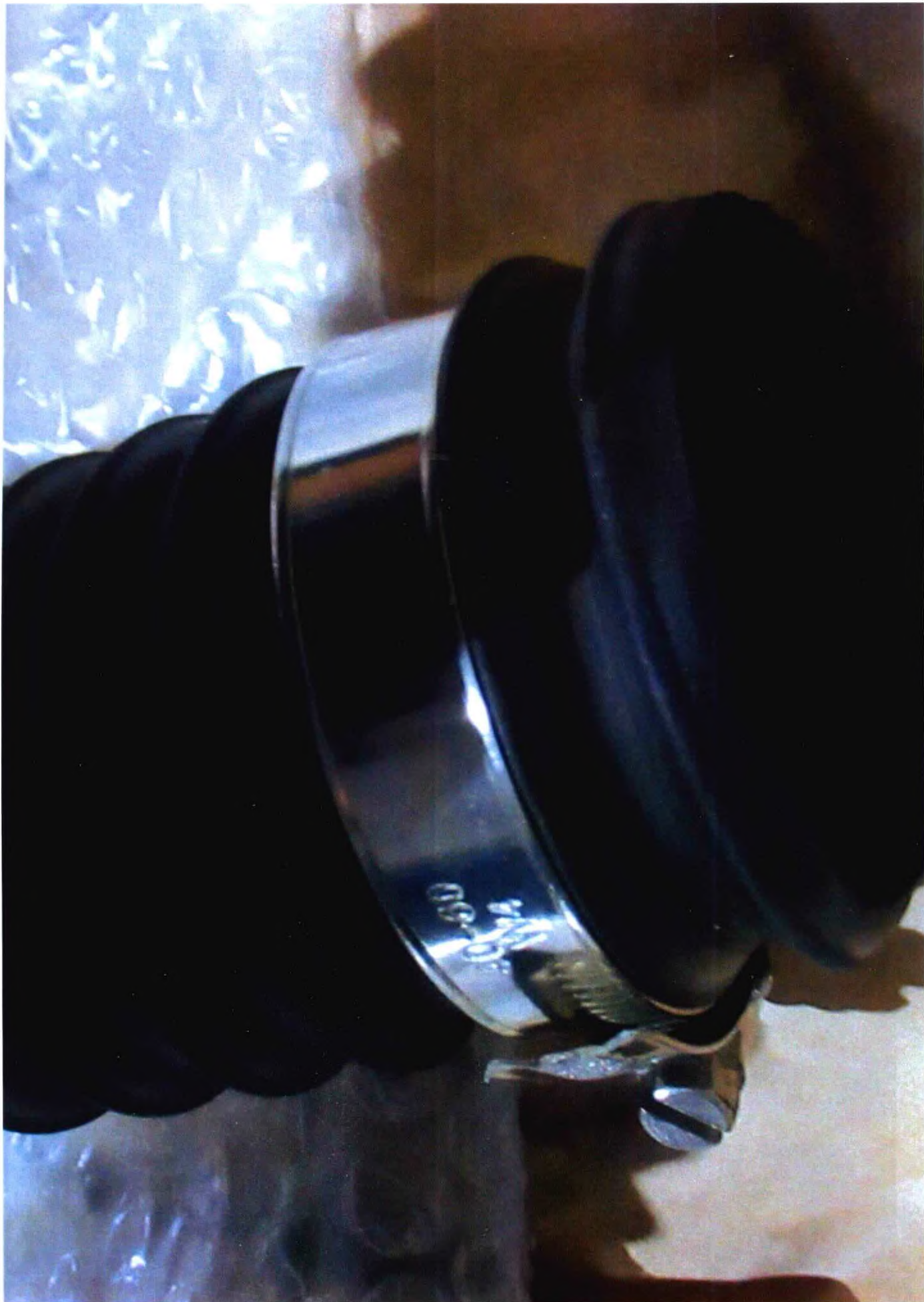
Фото 4.2. Металлический хомут (Metal strap)
